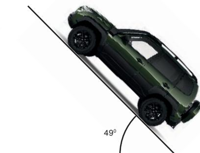
Угол преодолеваемого уклона
