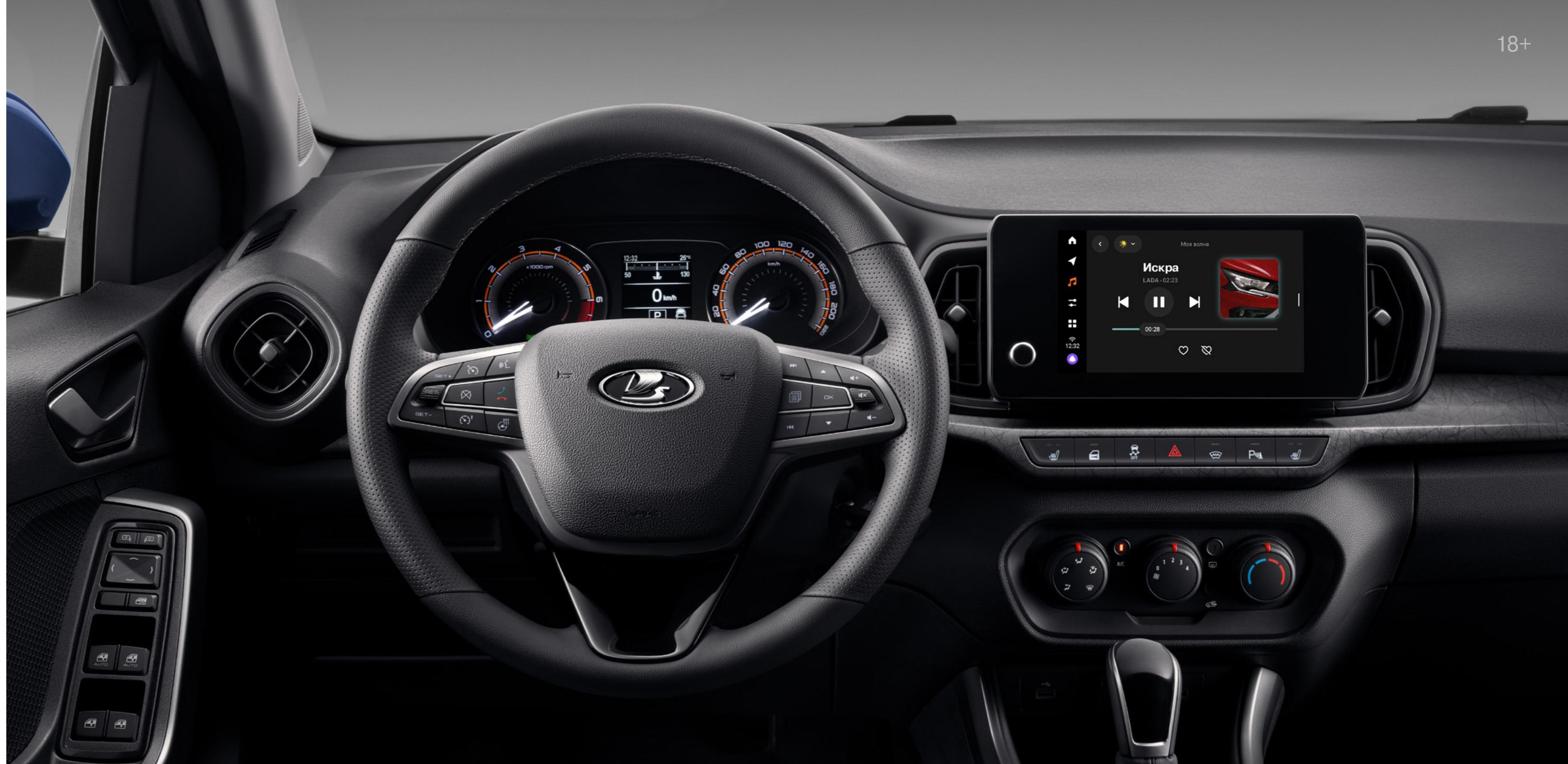
Интерьер LADA Iskra сочетает комфорт и практичность. Панель приборов с горизонтальным молдингом и ромбовидными воздуховодами имеет узнаваемый облик. Горизонтальное расположение элементов позволяет разместить органы управления в более эргономичных для водителя и пассажиров зонах.
