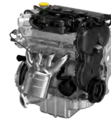
Двигатель 21129 1,6 л 16-кл., 78 кВт (106 л. с.)
