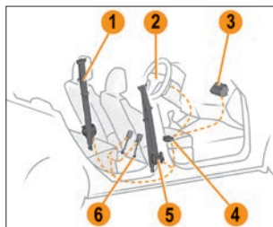
Схема устройства системы пассивной безопасности (в варианном исполнении)
