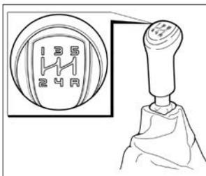
**Рис. 36.** Рычаг переключения передач в механической коробке передач
