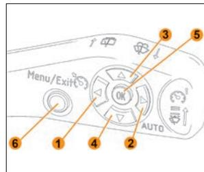
Рис. 31. Клавиши управления круиз-контролем и ограничителем скорости
