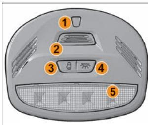
Рис. 18в. Блок освещения салона
