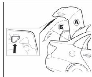
Рис. 26б. Внутренняя ручка крышки багажника (в варианном исполнении)
