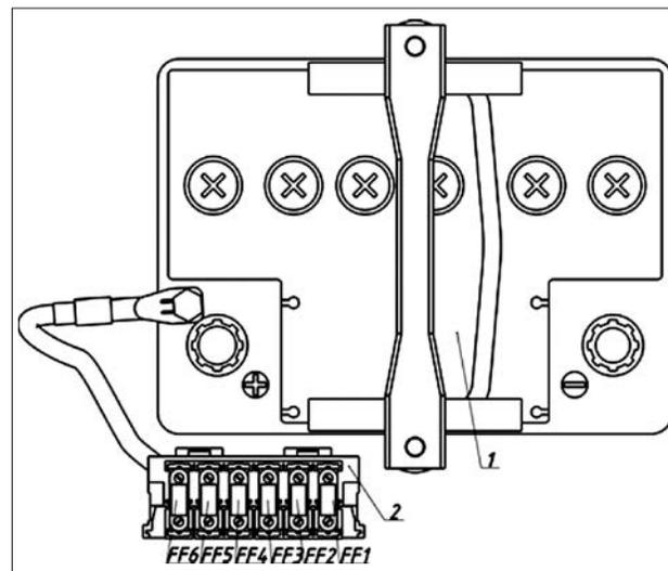
Рис. 55. Блок предохранителей
