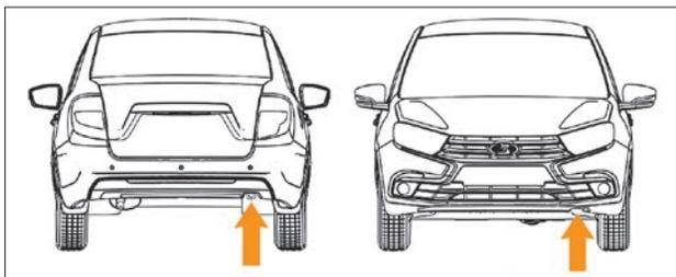
Рис. 42. Расположение буксирных проушин
