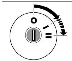
Рис. 35. Выключатель зажигания
