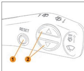
Рис. 29в. Переключатель стеклоочистителя с 3-мя клавишами управления
