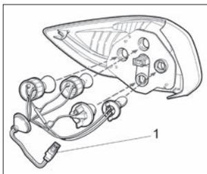
Рис. 57б. Задний фонарь автомобиля с кузовом «лифтбек»
