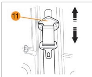
**Рис. 13д. Регулировка ремня безопасности (в варианном исполнении)**
