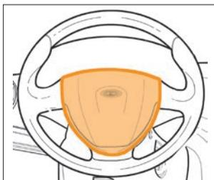
Рис. 14а. Зона размещения фронтальной подушки безопасности водителя (в варианном исполнении)
