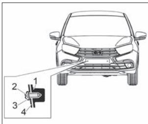
Рис. 40. Крепление переднего номерного знака
