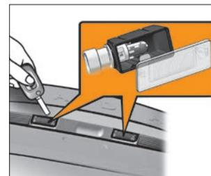
Рис. 58б. Посадочное место фонаря освещения номерного знака
