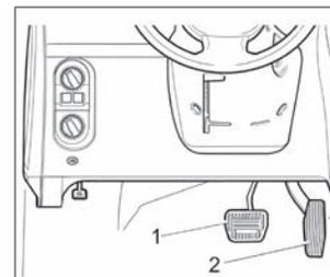
Рис. 36б. Педали при автоматической коробке передач
