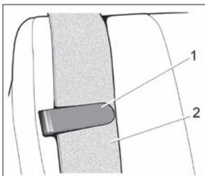
Рис. 11г. Держатель ремня безопасности (в варианном исполнении)
