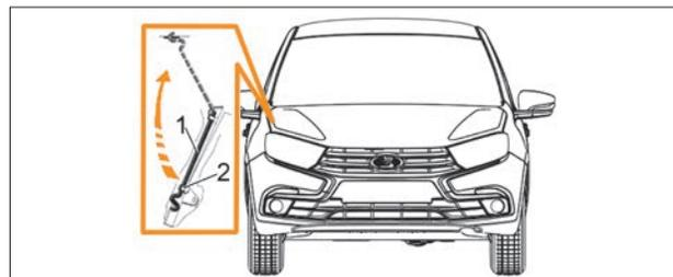
Рис. 24. Открывание капота
