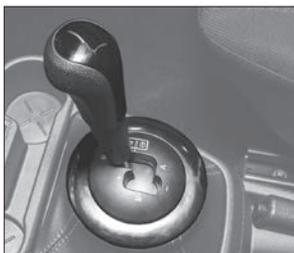
Рис. 36в. Рычаг переключения передач автоматизированной трансмиссии (АМТ)
