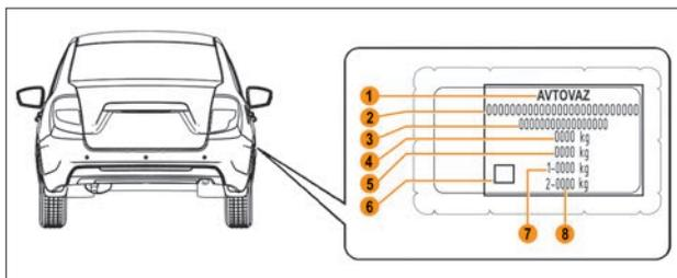
Рис. 63. Табличка изготовителя
