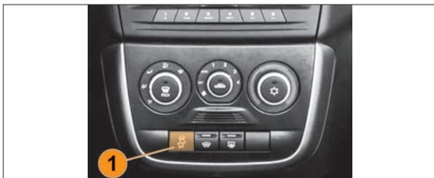
Рис. 416. Выключатель «ESC OFF»
