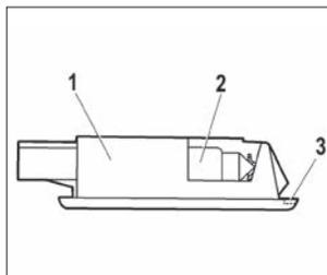
Рис. 60. Плафон освещения багажного отделения автомобиля с кузовами «лифтбек» и «универсал»
