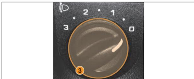
Рис. 306. Переключатель корректора ближнего света фар
