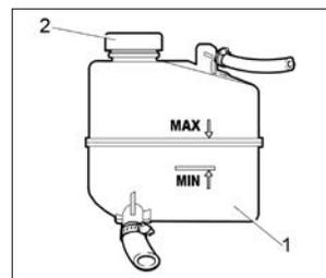
Рис. 45. Расширительный бачок
