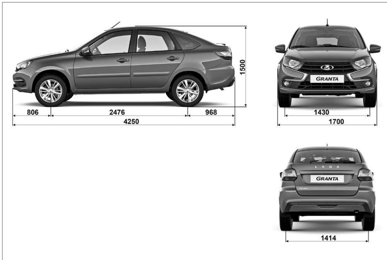
Рис. 626. Габаритные (справочные) размеры автомобиля с кузовом «лифтбек»
