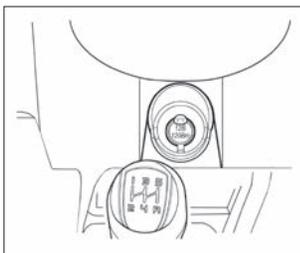
Рис. 21а. Патрон для подключения дополнительного электрооборудования (в варианном исполнении)
