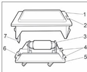
Рис. 59. Плафон освещения багажника автомобиля с кузовом «седан»
