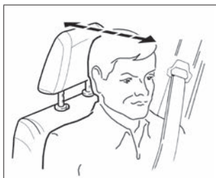
Рис. 11б. Оптимальное положение подголовника
