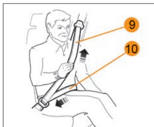
Рис. 13г. Правильное положение ремня безопасности
