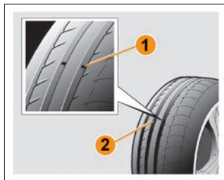
Рис. 6.8.7. Выступы-индикаторы на шинах
