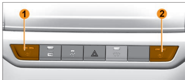
Рис. 2.1.6. Клавиши управления подогревом передних сидений (в варианном исполнении)
