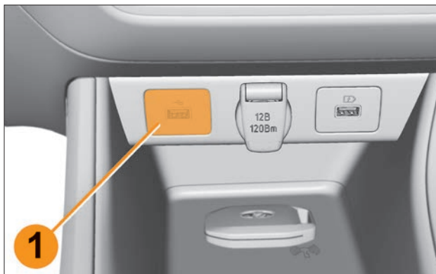
Рис. 4.6.5. USB-разъем для подключения USB-накопителя (в варианном исполнении)
