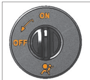
Рис. 2.5.12. Выключатель фронтальной подушки безопасности пассажира (в варианном исполнении)
