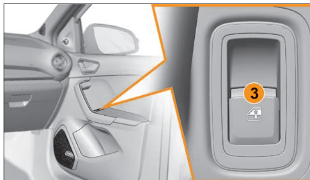
Рис. 4.1.2. Клавиша управления электростеклоподъемником с места переднего пассажира (в варианном исполнении)
