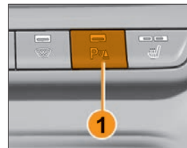
Рис. 5.15.2. Клавиша отключения СБП (в вариантном исполнении)
