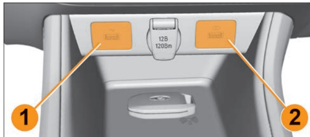
Рис. 4.4.2. USB-розетки 5 В для водителя и переднего пассажира (в варианном исполнении)
