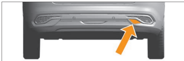
Рис. 6.13.2. Место установки буксирной проушины в заднем бампере
