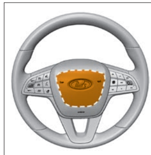
Рис. 2.5.1. Место установки фронтальной подушки безопасности водителя
