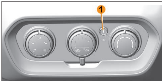
Рис. 3.10.4. Выключатель обогрева наружных зеркал (в варианном исполнении)
