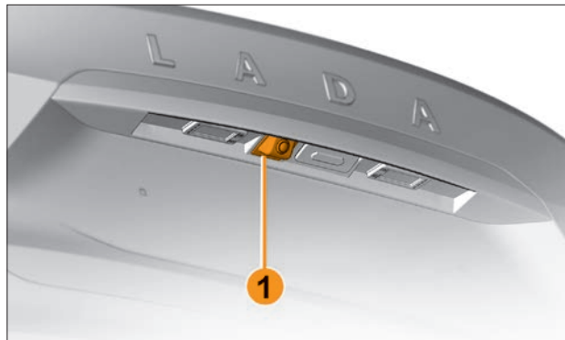
Рис. 5.16.1. Камера заднего вида (в варианном исполнении)
