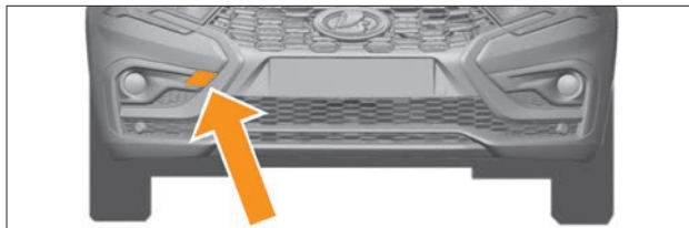
Рис. 6.13.1. Место установки буксирной проушины в переднем бампере
