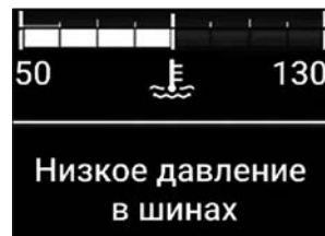
Рис. 6.8.9. Сообщение «Низкое давление в шинах» на информационном дисплее
