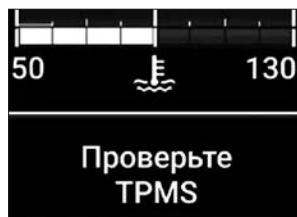
Рис. 6.8.13. Сообщение «Проверьте TPMS» на информационном дисплее
