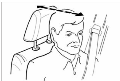
Рис. 11б. Оптимальное положение подголовника
