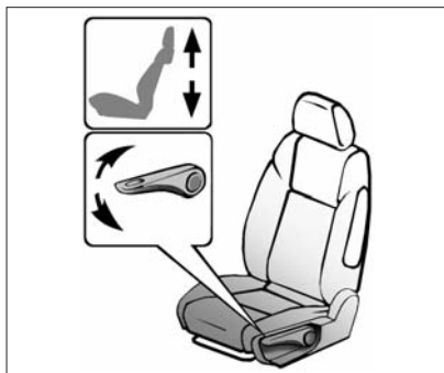
Рис. 9а. Переднее сиденье (вариантное исполнение)
