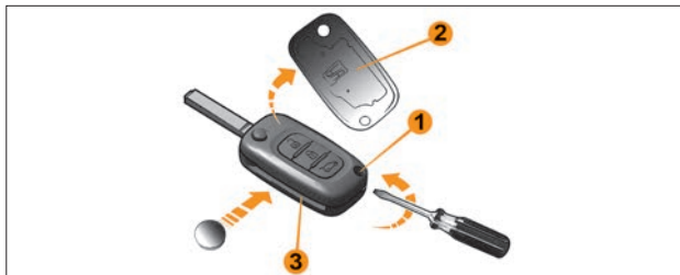
Рис. 6.11.1. Замена элемента питания в ПДУ (в варианном исполнении)
