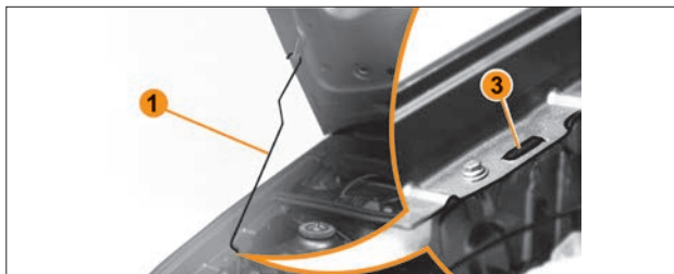
Рис. 6.2.4. Установка упора капота
