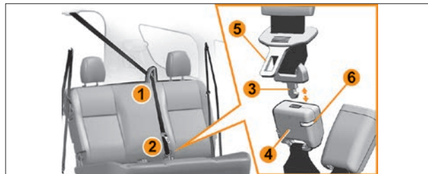
Рис. 2.5.4а. Фиксация среднего ремня безопасности без пассажира
