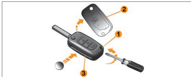
Рис. 6.11.1а. Замена элемента питания в ПДУ
