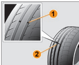
Рис. 6.9.4. Выступы-индикаторы на шинах
