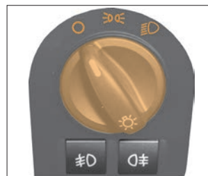
Рис. 14а. Переключатель наружного освещения
