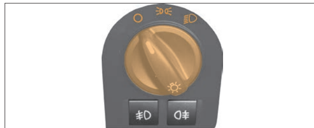
Рис. 14а. Переключатель наружного освещения
