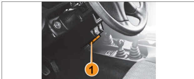
Рис. 276. Зона расположения громкоговорителя системы вызова экстренных оперативных служб (в варианном исполнении)
