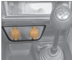
Рис. 17. Розетки для подключения дополнительного электрооборудования в салоне
