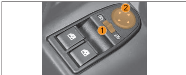
Рис. 28. Блок управления электроприводом наружных зеркал
