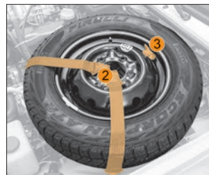
Рис. 44. Укладка и крепление домкрата и запасного колеса
