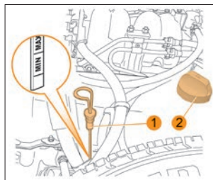
Рис. 34. Проверка уровня масла в картере двигателя
