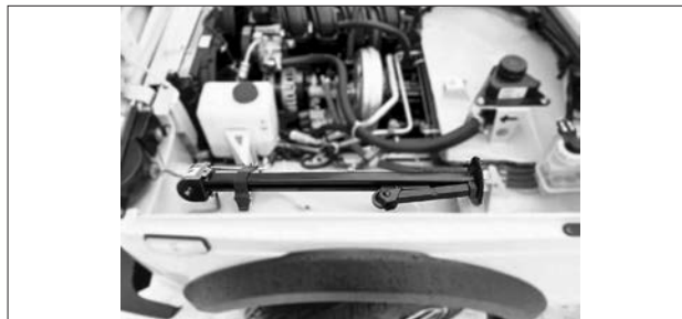
Рис. 9. Укладка и крепление домкрата
