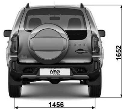
Рис. 90. Габаритные (справочные) размеры автомобиля (в варианном исполнении)
