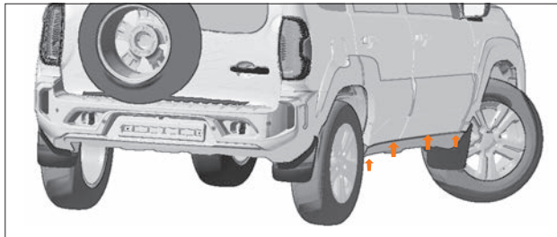
Рис. 89. Дренажные отверстия дверей и порогов
