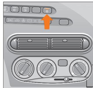
Рис. 62. Предохранение стёкол от запотевания и замерзания
