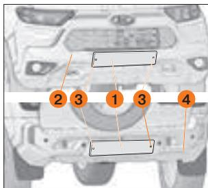
Рис. 63. Крепление номерных знаков
