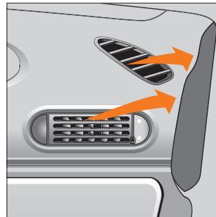
Рис. 56. Дефлекторы подачи воздуха на стекла передних дверей
