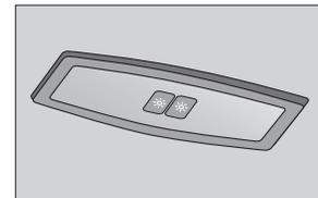
Рис. 31. Задний плафон освещения салона (в варианном исполнении)
