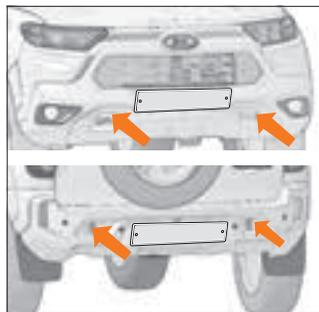
Рис. 65. Буксирование проушины
