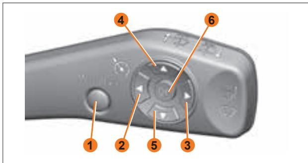
Рис. 41д. Клавиши управления круиз-контролем и ограничителем скорости
