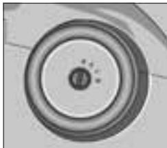
Рис. 46. Выключатель зажигания
