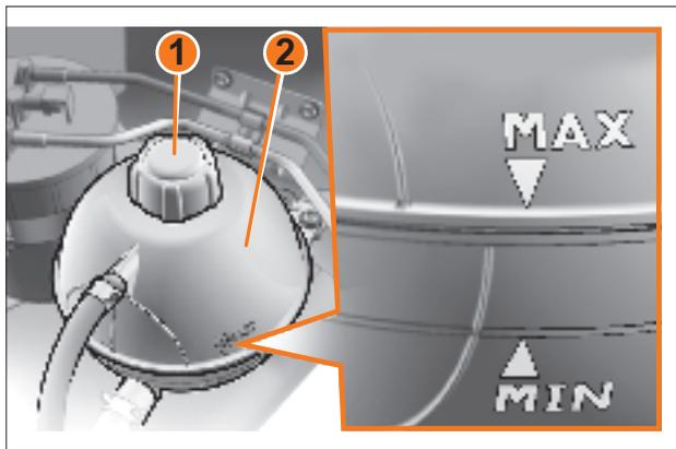
Рис. 72. Проверка уровня охлаждающей жидкости в расширительном бачке
