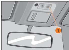
**Рис. 69а. Блок интерфейса пользователя (БИП) (в варианном исполнении)**
