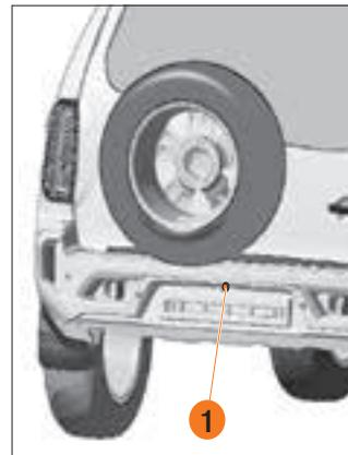
Рис. 67. Камера заднего вида
