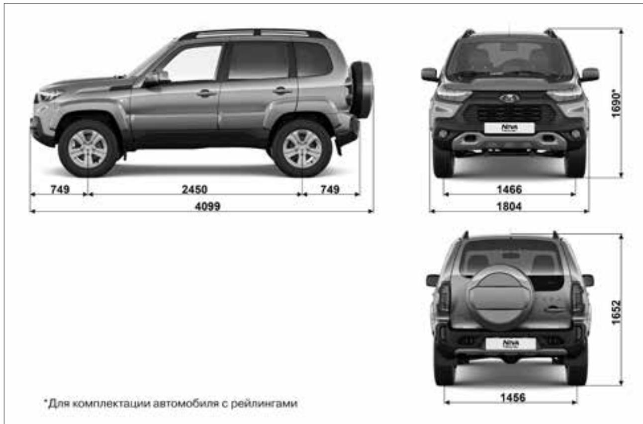
Рис. 87. Габаритные (справочные) размеры автомобиля (в варианном исполнении)
