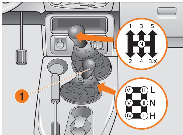
Рис. 48. Положение рычагов трансмиссии
