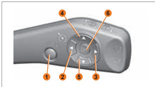
Рис. 41г. Переключатель стеклоочистителя с шестью клавишами управления
