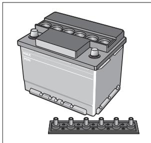
Рис. 76. Проверка уровня электролита в аккумуляторной батарее
