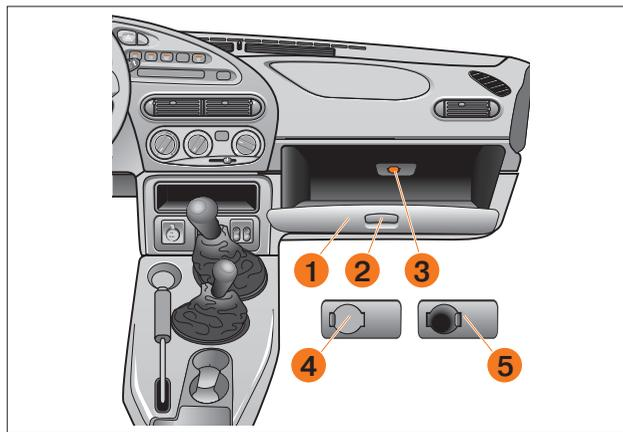
Рис. 33. Охлаждаемый вещевой ящик (в варианном исполнении)
