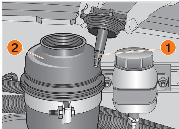
Рис. 75а. Бачок гидроусилителя руля (в варианном исполнении)
