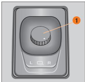
Рис. 28. Блок управления наружными зеркалами
