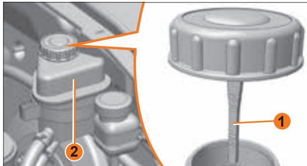
Рис. 75б. Бачок гидроусилителя руля (в варианном исполнении)
