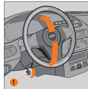
Рис. 6е. Рукоятка регулировки положения рулевой колонки
