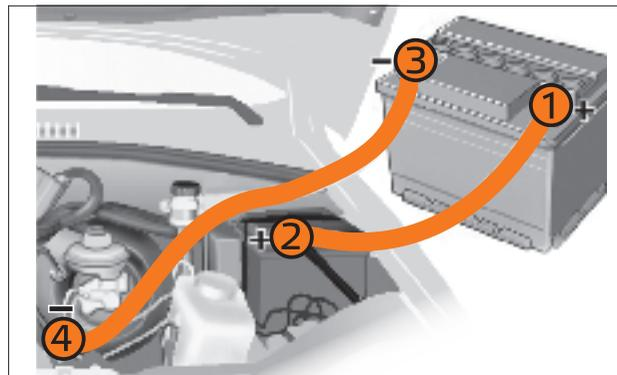
Рис. 64. Схема подключения пусковых проводов к вспомогательной батарее
