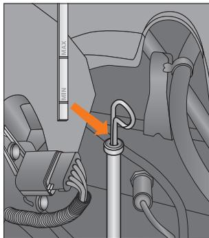
Рис. 71. Проверка уровня масла в картере двигателя
