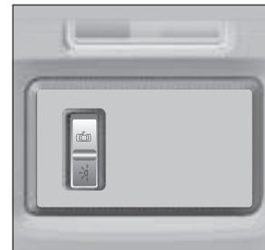
Рис. 30. Передний плафон оборудования салона
