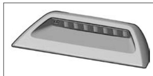
Рис. 15. Дополнительный сигнал торможения (кузов «SE»)
