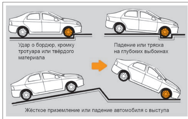
Рис. 10. Примеры ситуаций с возможным срабатыванием подушек безопасности
