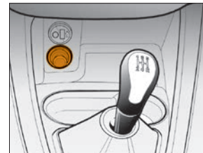
Рис. 2. Розетка для подключения дополнительного электрооборудования
