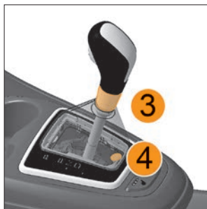
Рис. 21. Снятие блокировки рычага переключения передач
