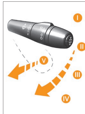
Рис. 17. Рычаг переключателя стеклоочистителей
