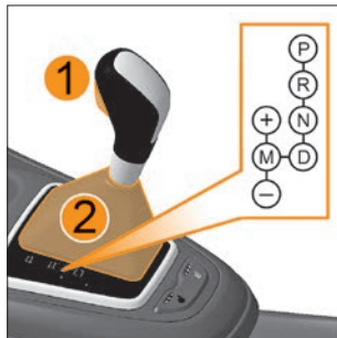
Рис. 20. Рычаг переключения передач автоматической коробки передач
