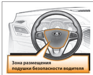
Рис. 4. Место установки фронтальной подушки безопасности водителя
