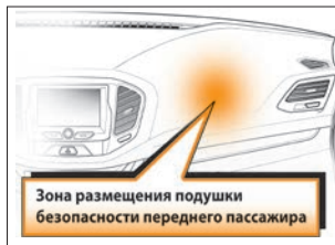
Рис. 5. Место установки фронтальной подушки безопасности переднего пассажира (в варианном исполнении)
