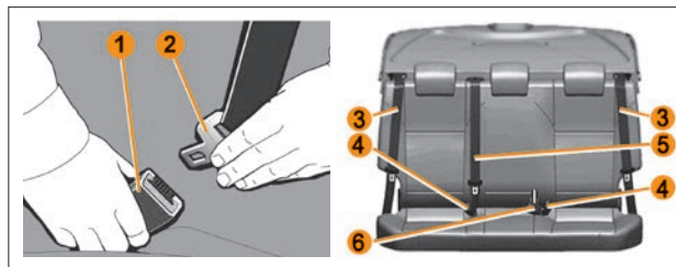
Рис. 1. Регулировка ремня безопасности
