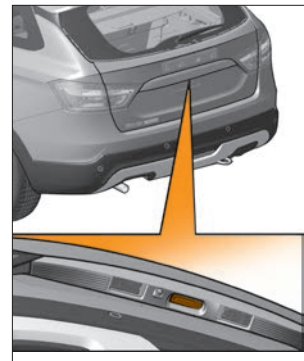
Рис. 14. Выключатель открывания замка багажника
