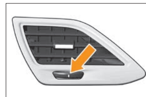
Рис. 8. Боковое левое сопло вентиляции салона (рукоятка управления заслонками сопла в положении «ЗАКРЫТО»)
