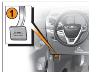
Рис. 1. Рукоятка для открытия капота
