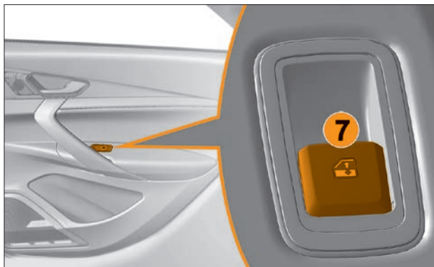
Рис. 4.1.3. Клавиша управления электростеклоподъемником с места заднего пассажира
