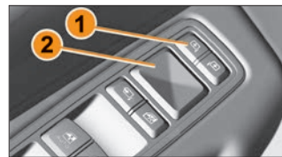
Рис. 3.11.3. Переключатель и джойстик управления электроприводом зеркал
