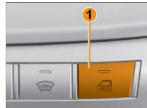
Рис. 1.3.2. Кнопка блокировки/разблокировки замков дверей
