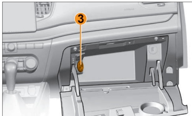
Рис. 4.5.3. Заслонка для охлаждения вещевого ящика (в варианном исполнении)
