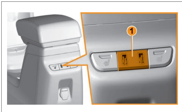
Рис. 4.4.7. USB-розетки 5 В для задних пассажиров (в варианном исполнении)
