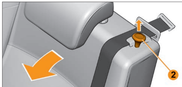
Рис. 2.2.6. Ручка фиксатора спинки сиденья второго ряда
