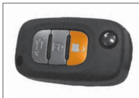
Рис. 1.2.1. Кнопка «РАЗБЛОКИРОВКА» ПДУ
