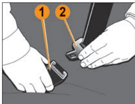
Рис. 2.4.3. Пристёгивание ремнём безопасности
