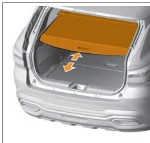
Рис. 5.8.4. Натяжная шторка багажного отделения
