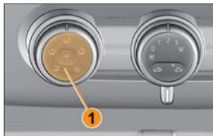
Рис. 3.11.5. Выключатель обогрева наружных зеркал (в варианном исполнении)
