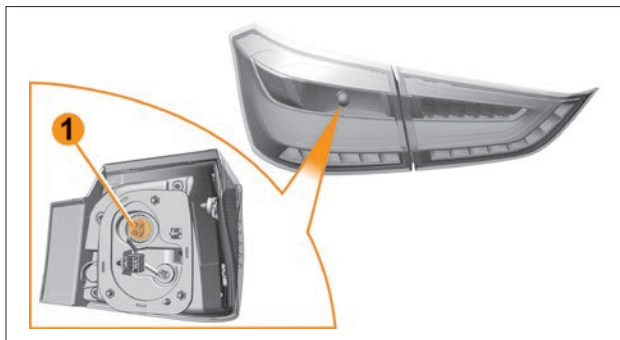
Рис. 6.12.1. Лампа указателя поворота в заднем фонаре
