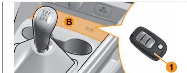
Рис. 5.10.2. Место размещения считывающего устройства
