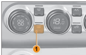
Рис. 3.11.6. Выключатель обогрева наружных зеркал (в варианном исполнении)
