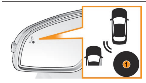
Рис. 5.16.1. Сигнализатор системы КСЗ (в вариантном исполнении)
