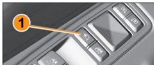
Рис. 3.11.4. Кнопка управления складыванием наружных зеркал (в варианном исполнении)
