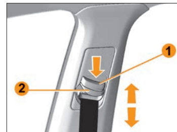
Рис. 2.4.4. Регулировка ремня безопасности передних сидений по высоте (в варианном исполнении)
