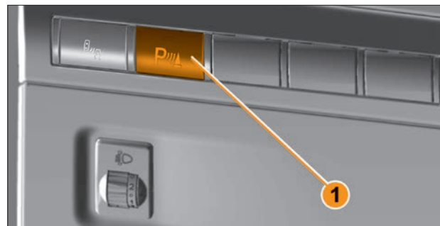
Рис. 5.15.3. Кнопка отключения СБП (в вариантном исполнении)
