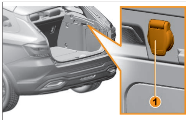
Рис. 4.4.4. Розетка 12 В в багажном отделении (в варианном исполнении)
