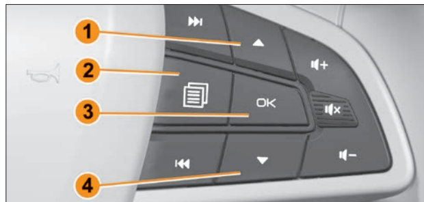
Рис. 3.3.2. Кнопки управления комбинацией приборов (в вариантном исполнении)
