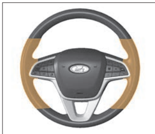
Рис. 3.4.9. Зоны максимального обогрева рулевого колеса
