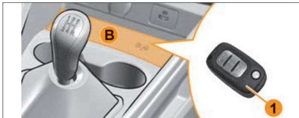
Рис. 5.10.2. Место размещения считывающего устройства
