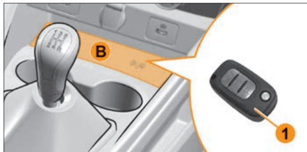
Рис. 3.5.3. Место размещения считывающего устройства
