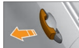
Рис. 1.4.1. Открытие боковых дверей снаружи
