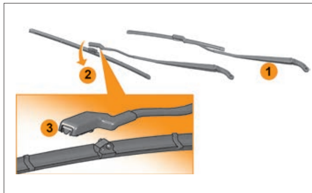
Рис. 6.7.2. Замена щеток стеклоочистителя ветрового стекла
