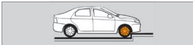
Рис. 2.5.8. Пример ситуации с возможным срабатыванием фронтальных подушек безопасности при ударе о бордюр, кромку тротуара или твердый материал
