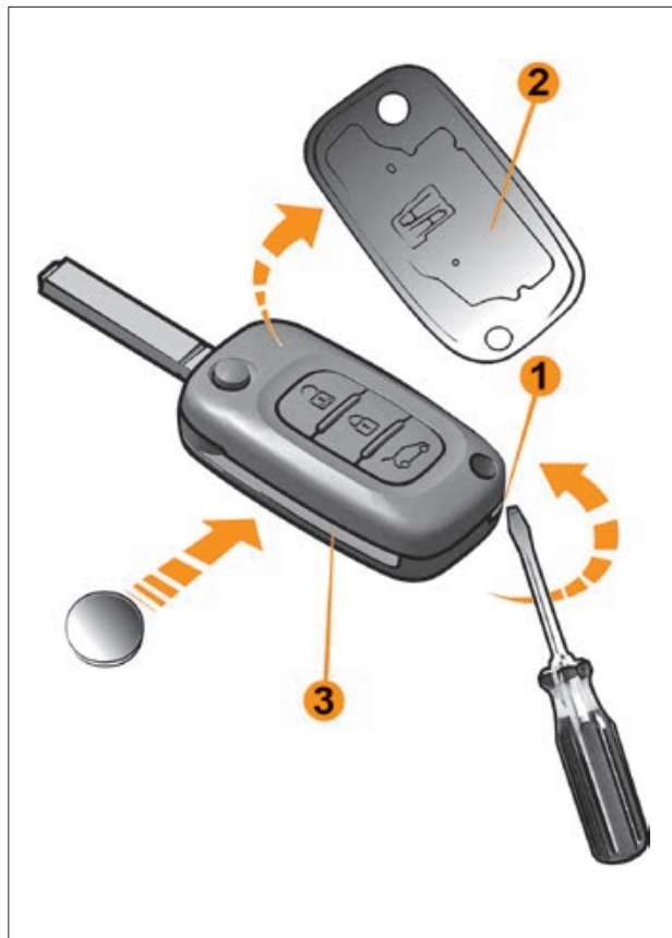
Рис. 6.10.1. Замена элемента питания в ПДУ
