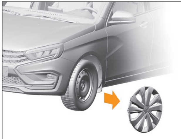
Рис. 6.8.4. Снятие декоративного колпака (в варианном исполнении)
