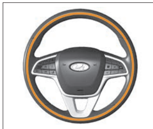
Рис. 3.4.8. Зоны обогрева рулевого колеса
