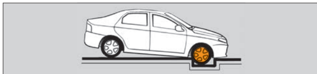
Рис. 2.5.9. Пример ситуации с возможным срабатыванием фронтальных подушек безопасности при падении или тряске на глубоких выбоинах
