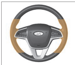
Рис. 3.4.9. Зоны максимального обогрева рулевого колеса
