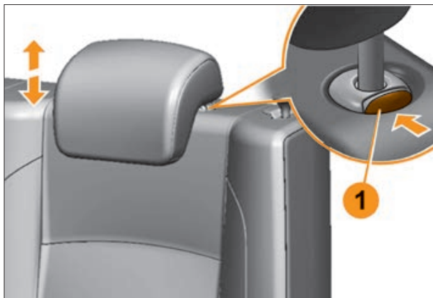
Рис. 2.2.1. Регулировка подголовников сиденья второго ряда
