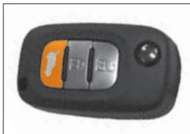
Рис. 1.2.3. Кнопка «ДВЕРЬ БАГАЖНОГО ОТДЕЛЕНИЯ» ПДУ
