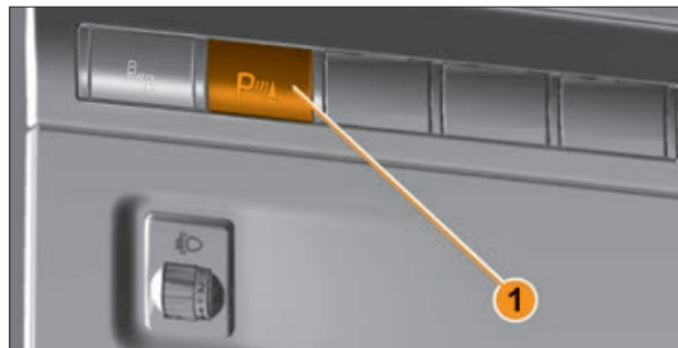
Рис. 5.15.3. Кнопка отключения СБП (в варианном исполнении)
