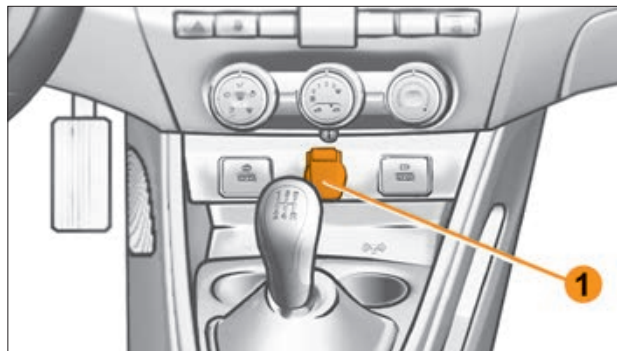
Рис. 4.4.1. Розетка 12 В для водителя и переднего пассажира (в варианном исполнении)
