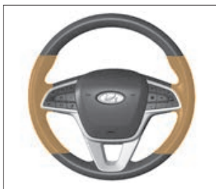
Рис. 3.4.9. Зоны максимального обогрева рулевого колеса
