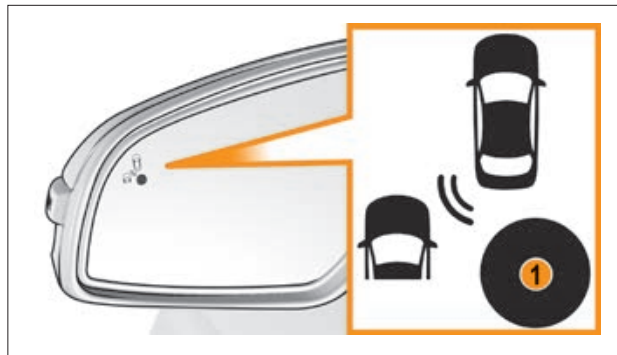
Рис. 5.16.1. Сигнализатор системы КСЗ (в варианном исполнении)
