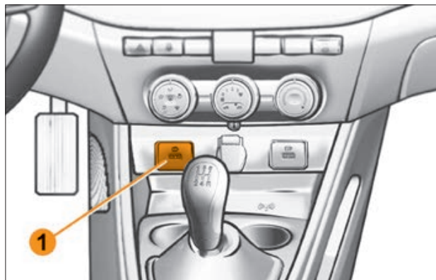
Рис. 4.6.5. USB-разъем для подключения USB-накопителя (в варианном исполнении)
