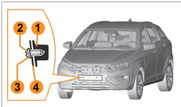
Рис. 5.1.1. Установка переднего номерного знака
