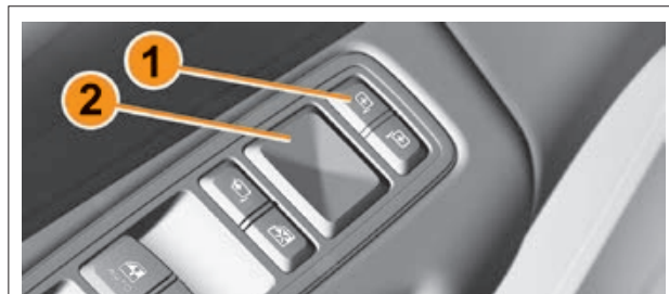
Рис. 3.11.3. Переключатель и джойстик управления электроприводом зеркал
