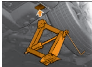
Рис. 6.8.7. Место для установки домкрата при замене переднего колеса
