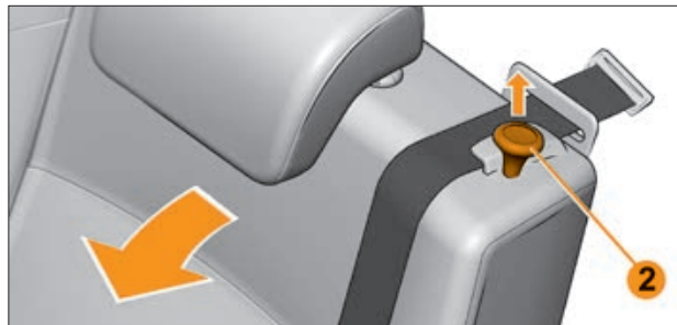
Рис. 2.2.6. Ручка фиксатора спинки сиденья второго ряда
