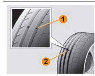
Рис. 6.8.9. Выступы-индикаторы на шинах
