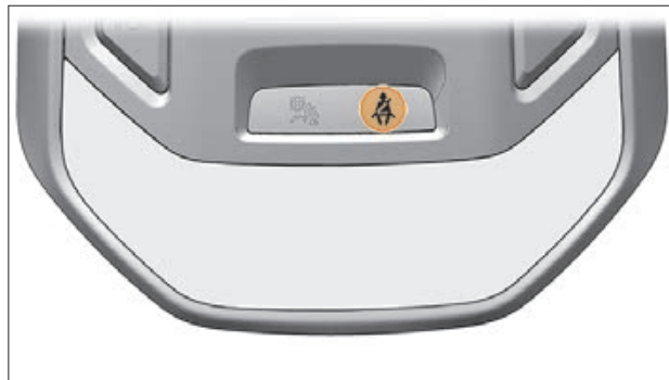
Рис. 2.4.1. Индикатор непристёгнутых ремней безопасности
