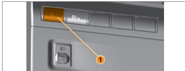
Рис. 5.16.5. Кнопка отключения системы КСЗ (в варианном исполнении)
