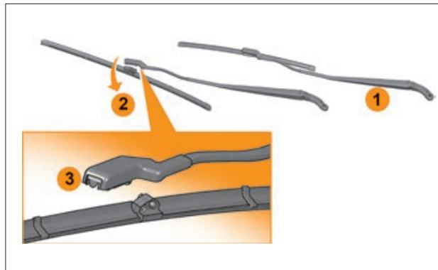
Рис. 6.7.2. Замена щеток стеклоочистителя ветрового стекла
