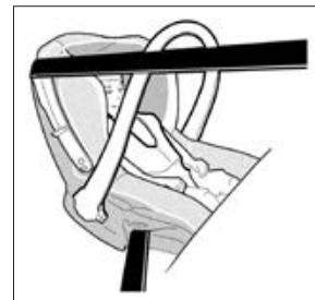
Рис. 2.6.3. Пример детского сиденья, установленного против направления движения автомобиля
