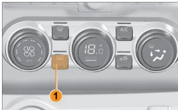
Рис. 3.11.6. Выключатель обогрева наружных зеркал (в варианном исполнении)
