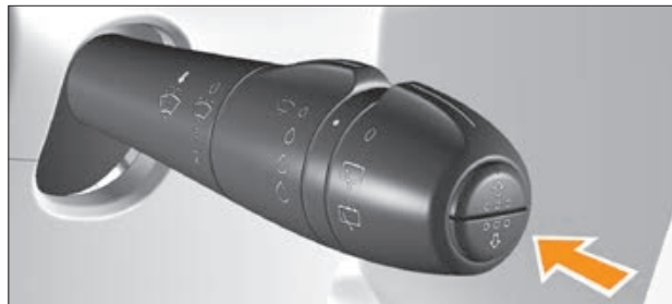
Рис. 3.2.5 а. Кнопки управления бортовым компьютером (в варианном исполнении)
