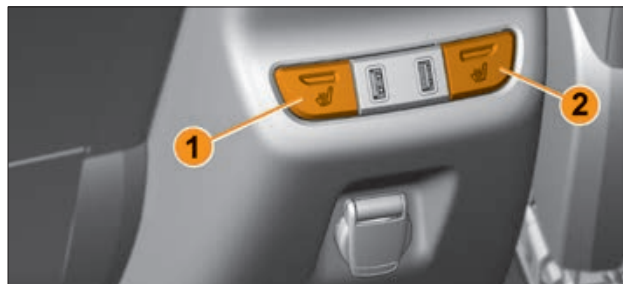
Рис. 2.2.3. Выключатели обогрева сиденья второго ряда (в вариантном исполнении)
