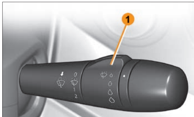
Рис. 3.9.5. Кольцо управления на правом рычаге подрулевого переключателя ( в варианном исполнении )
