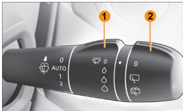
Рис. 3.9.6. Кольца управления на правом рычаге подрулевого переключателя ( в варианном исполнении )
