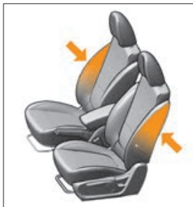
Рис. 2.5.3. Места установки боковых подушек безопасности для водителя и переднего пассажира (в варианном исполнении)
