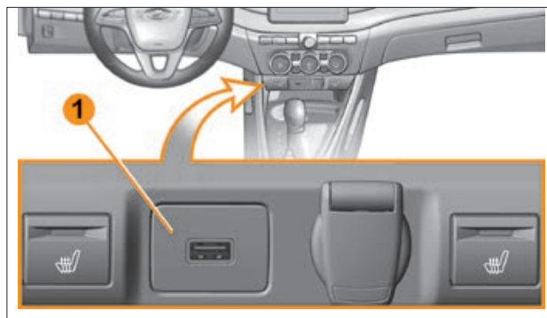
Рис. 4.4.6. USB-розетка 5 В для водителя и переднего пассажира (в варианном исполнении)
