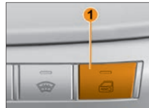
Рис. 1.3.2. Кнопка блокировки/разблокировки замков дверей
