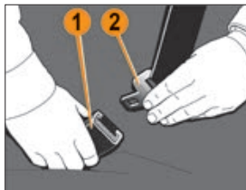
Рис. 2.4.3. Пристёгивание ремнём безопасности
