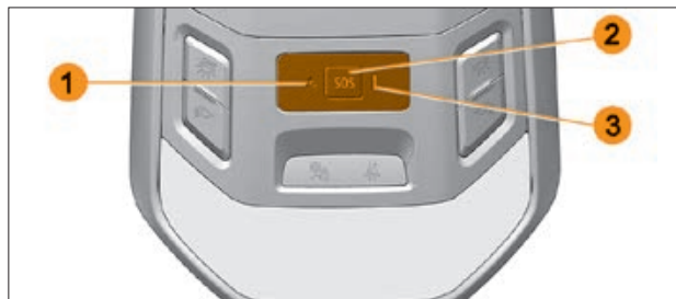
Рис. 2.7.1. Блок управления УВЭОС (в вариантном исполнении)
