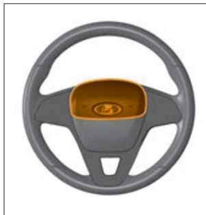
Рис. 3.4.2 а. Включатель звукового сигнала (в вариантном исполнении)
