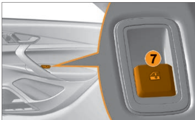
Рис. 4.1.3. Клавиша управления электростеклоподъемником с места заднего пассажира
