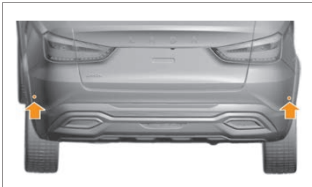
Рис. 5.16.4. Задние датчики системы КСЗ (в варианном исполнении)
