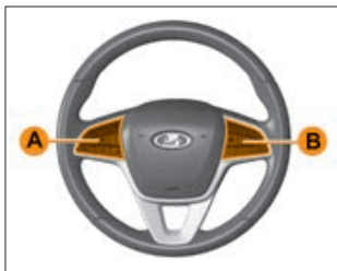
Рис. 3.4.3. Дополнительные блоки управления (в варианном исполнении)
