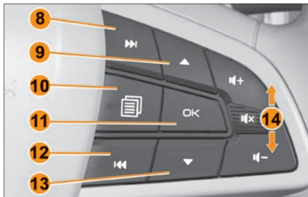
Рис. 3.4.7. Блок управления В (в варианном исполнении)
