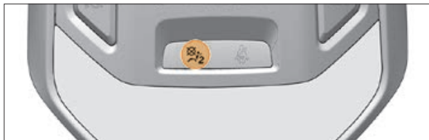
Рис. 2.5.15. Сигнализатор отключенной фронтальной подушки безопасности пассажира (в варианном исполнении)
