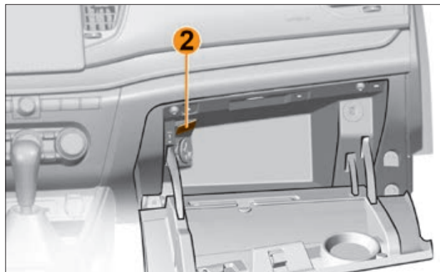
Рис. 4.5.2. Плафон освещения вещевого ящика (в варианте исполнения)
