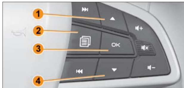
Рис. 3.3.2. Кнопки управления комбинацией приборов (в вариантном исполнении)
