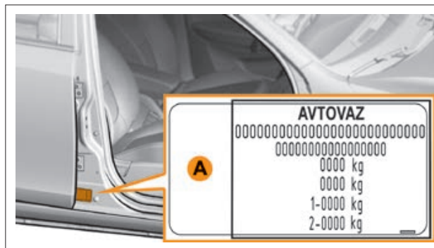
Рис. 7.1.1. Место размещения таблички изготовителя
