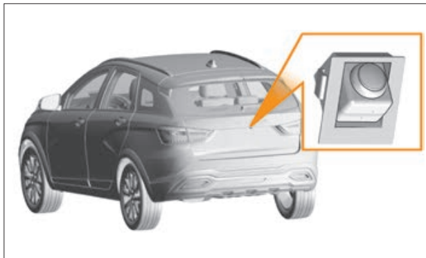
Рис. 5.17.1. Камера заднего вида (в варианном исполнении)
