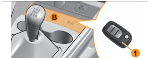
Рис. 5.10.2. Место размещения считывающего устройства
