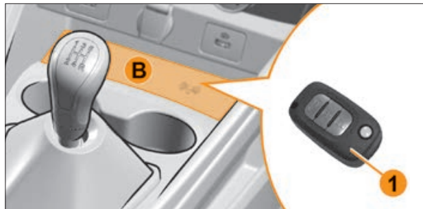
Рис. 3.5.3. Место размещения считывающего устройства
