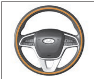
Рис. 3.4.8. Зоны обогрева рулевого колеса
