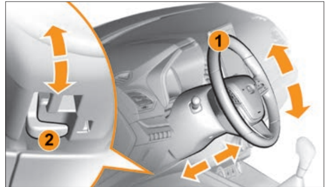
Рис. 3.4.1. Регулировка положения рулевого колеса
