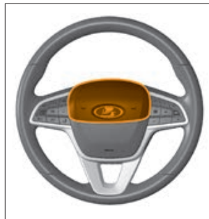
Рис. 3.4.2 б. Включатель звукового сигнала (в вариантном исполнении)
