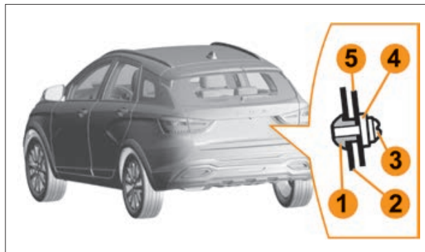
Рис. 5.1.2. Установка заднего номерного знака
