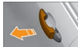
Рис. 1.4.1. Открытие боковых дверей снаружи
