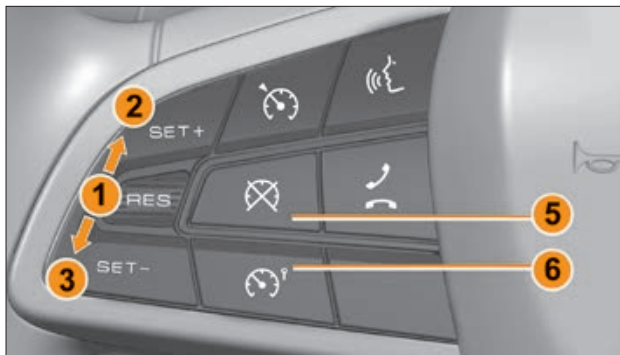
Рис. 5.12.2. Кнопки управления функцией «Ограничитель скорости»
