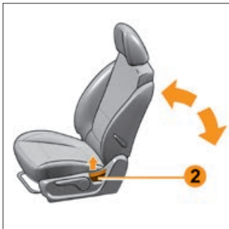
Рис. 2.1.2. Регулировка спинки переднего сиденья
