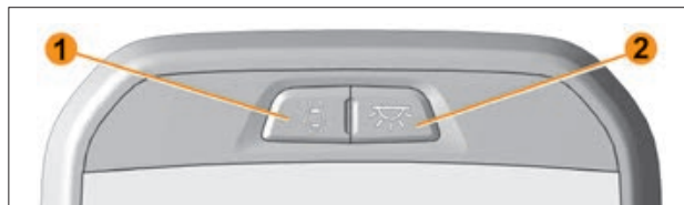
Рис. 4.2.3. Плафоны освещения заднего ряда сидений
