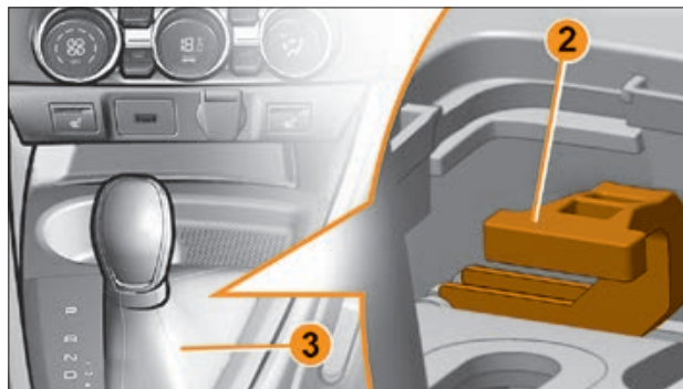
Рис. 5.6.2. Скоба разблокировки рычага переключения передач автоматической трансмиссии
