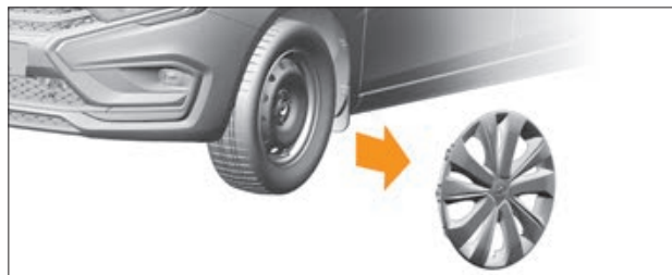
Рис. 6.8.4. Снятие декоративного колпака (в варианном исполнении)
