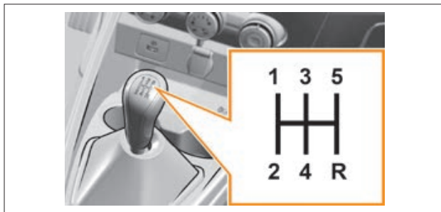
Рис. 3.7.1. Рычаг переключения передач механической трансмиссии
