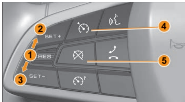
Рис. 5.12.1. Кнопки управления функцией «Круиз-контроль»
