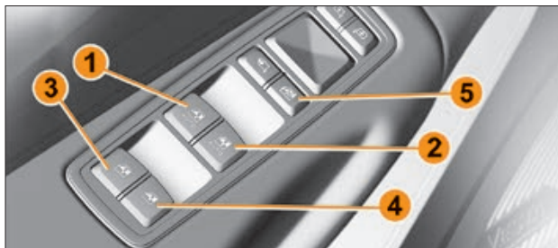
Рис. 4.1.1. Блок управления в двери водителя (в варианном исполнении)
