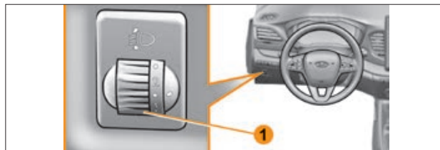
Рис. 3.10.1. Переключатель корректора угла наклона света фар
