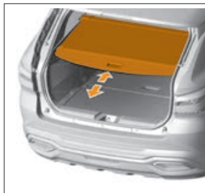
Рис. 5.8.4. Натяжная шторка багажного отделения
