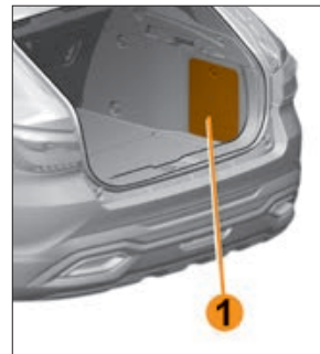
Рис. 5.8.5. Крышка ниши правого заднего колеса (в варианном исполнении)
