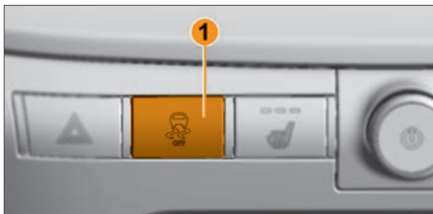
Рис. 5.14.1. Выключатель «ESC OFF» (в варианном исполнении)
