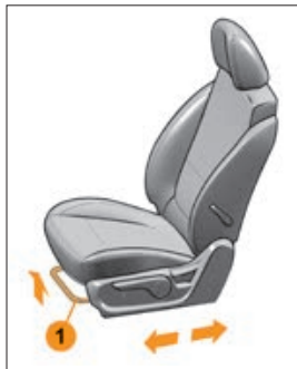
Рис. 2.1.1. Регулировка переднего сиденья
