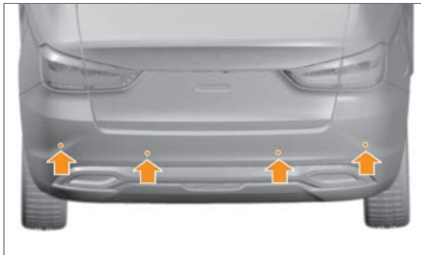
Рис. 5.15.1. Задние датчики четырехканальной СБП ( в варианном исполнении )
