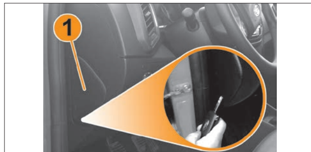
Рис. 8.29 Демонтаж крышки блока предохранителей и реле салона
