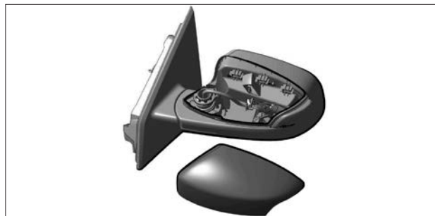
Рис. 8.19. Снятие накладки зеркала
