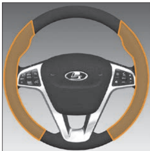
Рис. 3.11.5. Зоны максимального обогрева рулевого колеса (в варианном исполнении)
