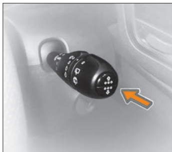
Рис. 3.7. Кнопки управления бортовым компьютером на переключателе стеклоочистителей
