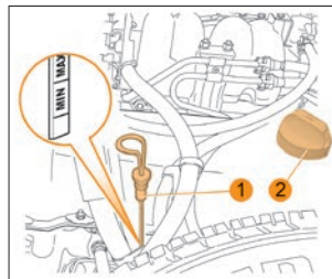
Рис. 34. Проверка уровня масла в картере двигателя
