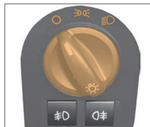
Рис. 14а. Переключатель наружного освещения
