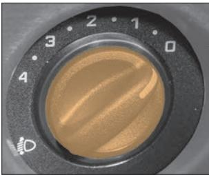
Рис. 14в. Переключатель корректора ближнего света фар
