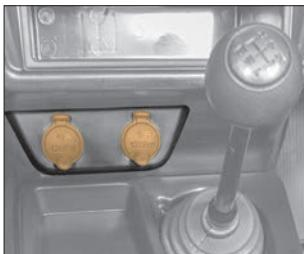
Рис. 17. Розетки для подключения дополнительного электрооборудования в салоне
