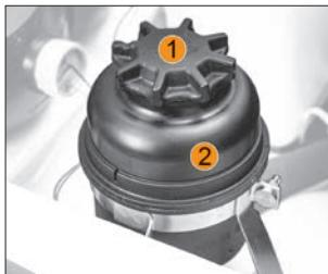
Рис. 37. Проверка уровня жидкости в бачке гидроусилителя руля
