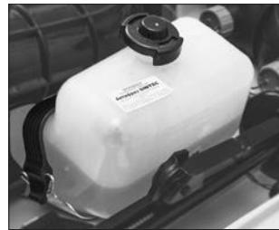
Рис. 35. Расширительный бачок
