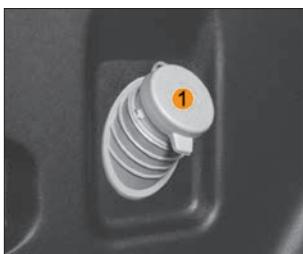
Рис. 40. Бачок омывателя заднего стекла
