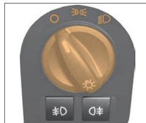
**Рис. 14а. Переключатель наружного освещения**
