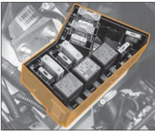
Рис. 49. Монтажный блок в моторном отсеке
