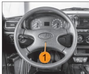
Рис. 31. Включатель звукового сигнала
