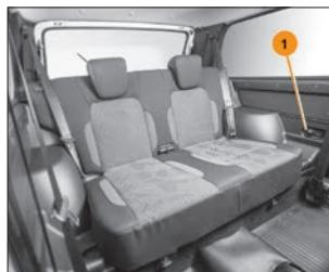
Рис. 4. Местоположение ручки привода замка двери багажного отделения LADA 4x4 (3 двери)
