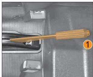
Рис. 23. Рычаг стояночного тормоза
