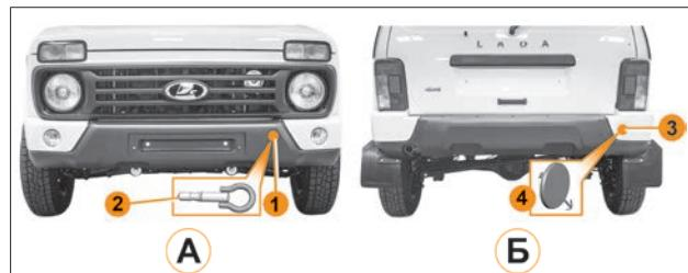
Рис. 33. Место установки буксировочной проушины
