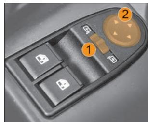
Рис. 28. Блок управления электроприводом наружных зеркал
