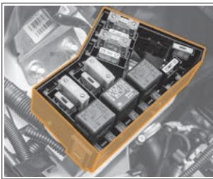
Рис. 49. Монтажный блок в моторном отсеке
