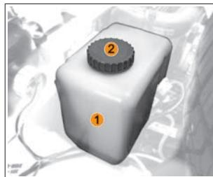
Рис. 39. Бачок омывателя ветрового стекла
