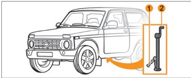
Рис. 43. Подъём автомобиля при замене колес
