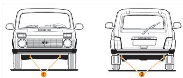
Рис. 32. Проушины для буксировки
