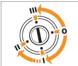
Рис. 20. Выключатель зажигания
