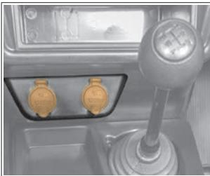
Рис. 17. Розетки для подключения дополнительного электрооборудования в салоне
