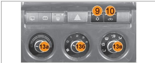
Рис. 25. Блок управления отопительно-вентиляционной установкой (вариантное исполнение)
