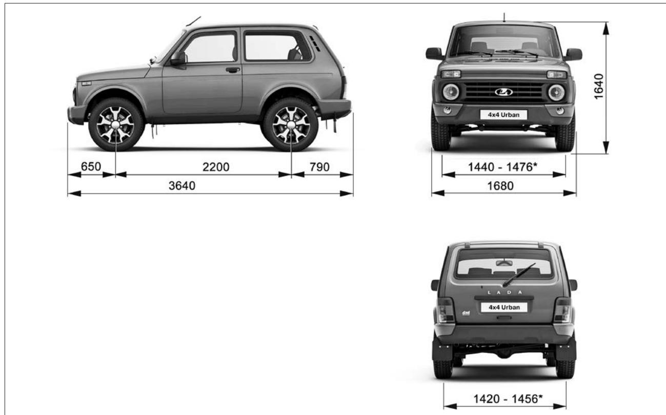
Рис. 54. Габаритные размеры автомобиля LADA 4x4 Urban 3 дв.
