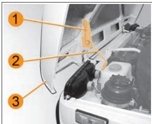
Рис. 7. Упор капота
