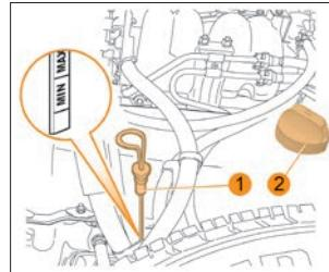
Рис. 34. Проверка уровня масла в картере двигателя
