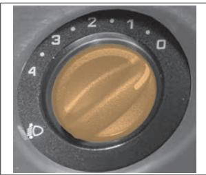
Рис. 14в. Переключатель корректора ближнего света фар
