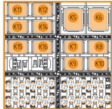
Рис. 50. Схема монтажного блока в салоне с нумерацией предохранителей и реле
