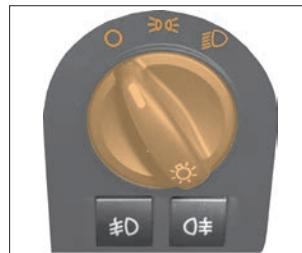
Рис. 14а. Переключатель наружного освещения
