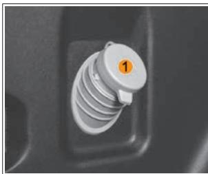
Рис. 40. Бачок омывателя заднего стекла
