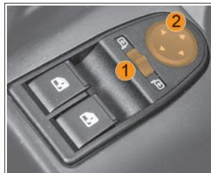
Рис. 28. Блок управления электроприводом наружных зеркал
