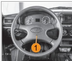
Рис. 31. Включатель звукового сигнала
