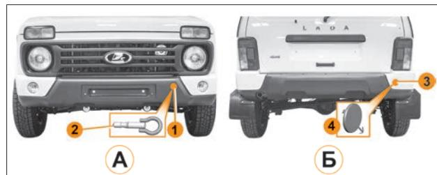
Рис. 33. Место установки буксировочной проушины
