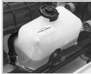
Рис. 35. Расширительный бачок
