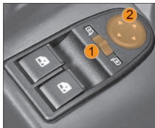
Рис. 28. Блок управления электроприводом наружных зеркал
