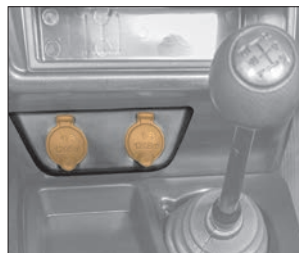
Рис. 17. Розетки для подключения дополнительного электрооборудования в салоне
