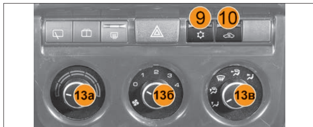
Рис. 25. Блок управления отопительно-вентиляционной установкой (вариантное исполнение)
