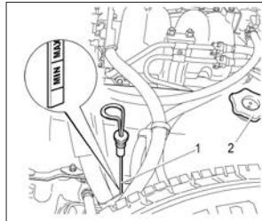
Рис. 35. Проверка уровня масла в картере двигателя
