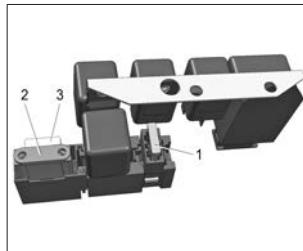
Рис. 54. Блок предохранителей и реле
