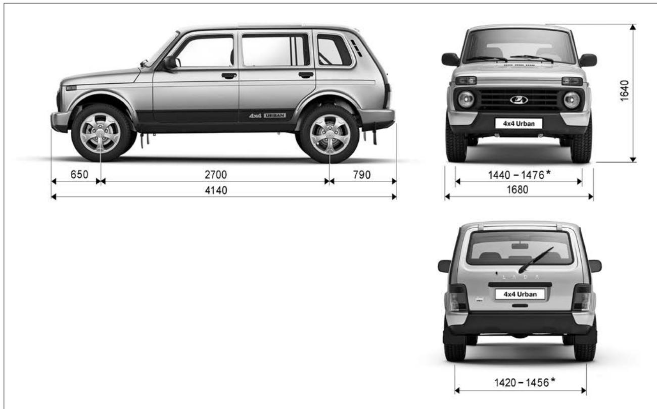
Рис. 58. Габаритные размеры автомобиля LADA 4x4 Urban 5 дв.
