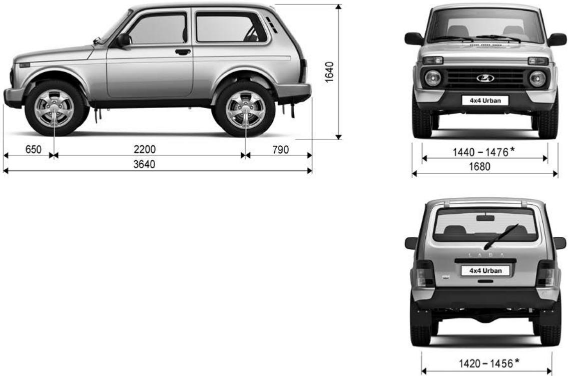
Рис.57. Габаритные размеры автомобиля LADA 4x4 Urban 3 дв.
