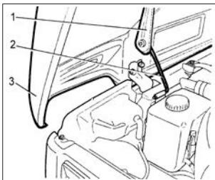
Рис. 7. Упор капота
