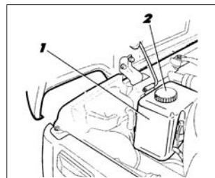
Рис. 40. Бачок омывателя
