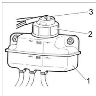
Рис. 37. Бачок гидропривода тормозов и сцепления
