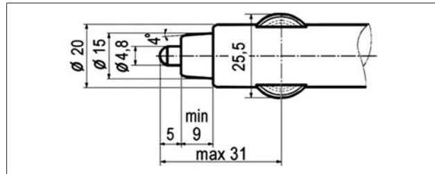
Рис. 18. Вилка для подключения дополнительного электрооборудования
