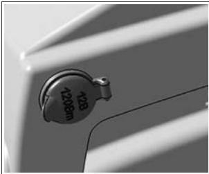
Рис. 17. Розетка для подключения дополнительного электрооборудования в багажнике
