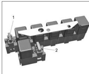
Рис. 53. Блок предохранителей и реле
