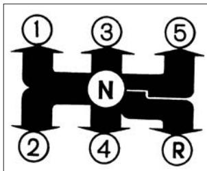
Рис. 23. Схема переключения передач
