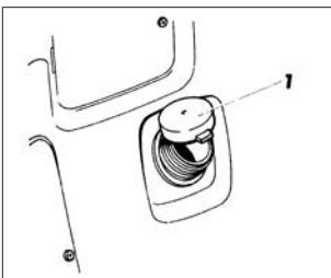
Рис. 41. Бачок омывателя
