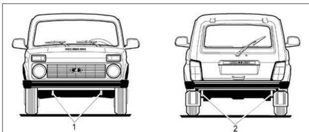
Рис. 33. Проушины для буксировки
