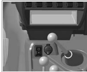
Рис. 16. Розетка для подключения дополнительного электрооборудования в салоне
