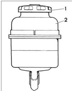
Рис. 38. Проверка уровня жидкости в бачке гидроусилителя руля
