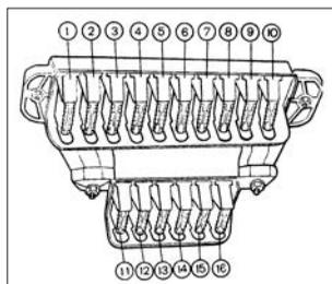
Рис. 51. Плавкие предохранители
