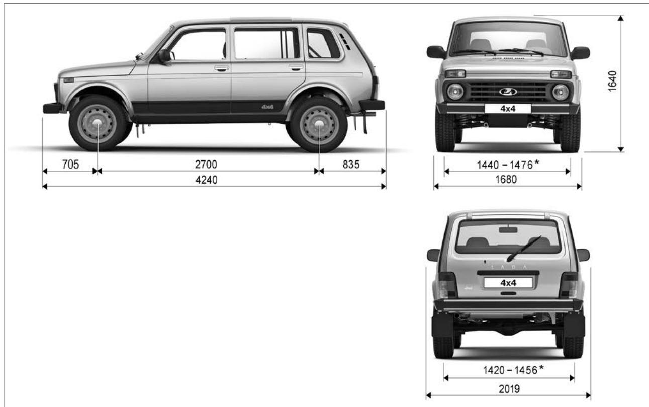
Рис. 56. Габаритные размеры автомобиля LADA 4x4 5 дв.
