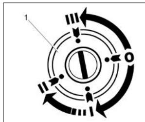
Рис. 20. Выключатель зажигания
