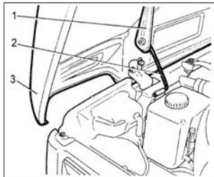
Рис. 7. Упор капота
