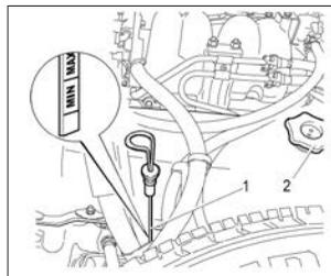
Рис. 35. Проверка уровня масла в картере двигателя
