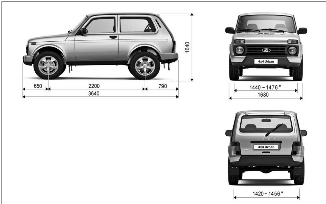
Рис. 57. Габаритные размеры автомобиля LADA 4x4 Urban 3 дв.
