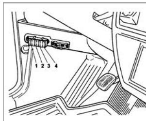
Рис. 52. Дополнительные предохранители
