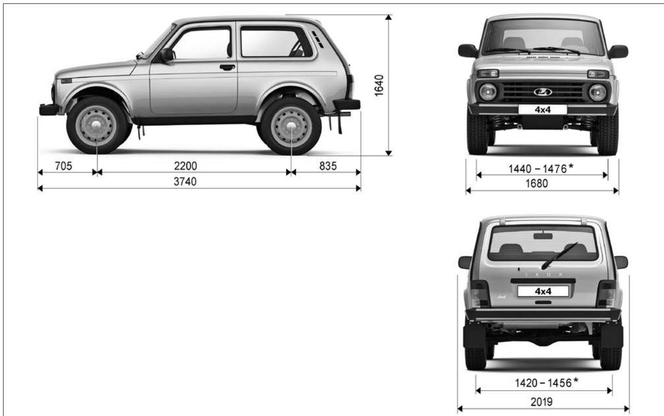
Рис. 55. Габаритные размеры автомобиля LADA 4x4 3 дв.
