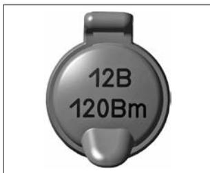
12-вольтовых электрических приборов мощностью не более 120 Вт с максимальной силой тока 10А. Показатели электромагнитной совместимости должны соответствовать DIN VDE 40839.
