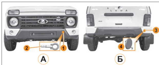
Рис. 33. Расположение вворачиваемых буксирных проушин (в варианном исполнении)
