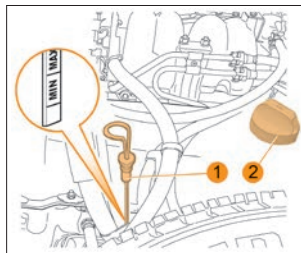
Рис. 34. Проверка уровня масла в картере двигателя
