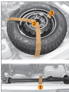
Рис. 44. Укладка и крепление домкрата и запасного колеса
