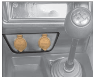
Рис. 17. Розетки для подключения дополнительного электрооборудования в салоне
