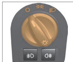
Рис. 14а. Переключатель наружного освещения
