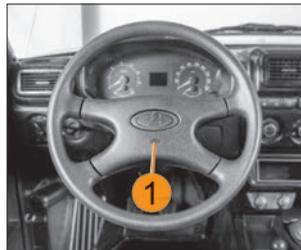
Рис. 31. Включатель звукового сигнала
