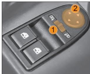
Рис. 28. Блок управления электроприводом наружных зеркал
