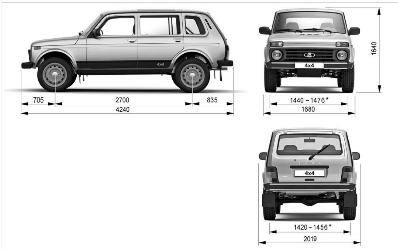
Рис. 53. Габаритные размеры автомобиля LADA 4x4 5 дв.
