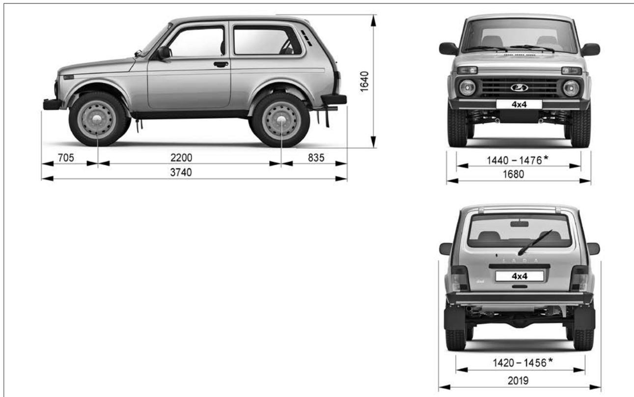
Рис. 52. Габаритные размеры автомобиля LADA 4x4 3 дв.
