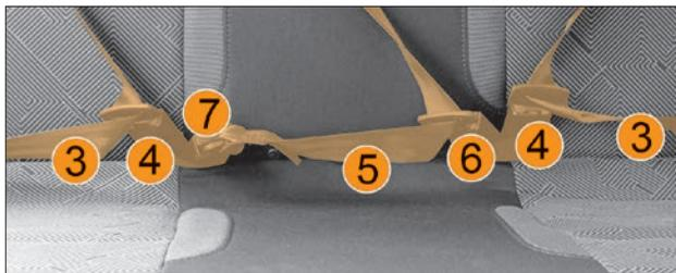
Рис. 9д. Ремни безопасности заднего сиденья LADA 4×4 (5 дверей)
