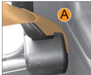
Рис. 9б. Лямка переднего ремня безопасности.
