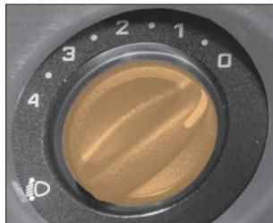
Рис. 14в. Переключатель корректора ближнего света фар
