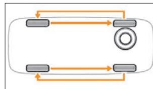
Рис. 41. Схема перестановки колес
