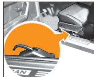
Рис. 4а. Местоположение ручки двери багажного отделения LADA 4x4 (5 дверей)
