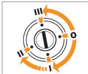
Рис. 20. Выключатель зажигания
