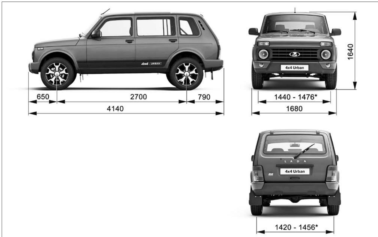
Рис. 55. Габаритные размеры автомобиля LADA 4x4 Urban 5 дв.
