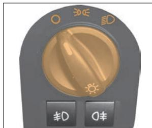
Рис. 14а. Переключатель наружного освещения
