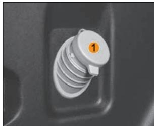
Рис. 40. Бачок омывателя заднего стекла
