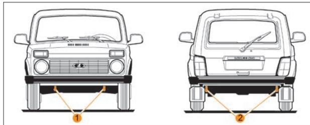
Рис. 32. Расположение буксирных проушин
