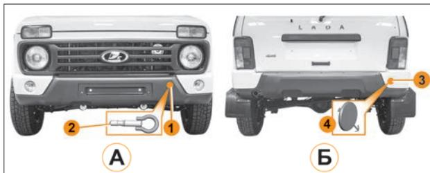
**Рис. 33. Расположение вворачиваемых буксирных проушин (в варианном исполнении)**
