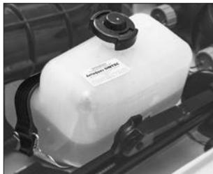
Рис. 35. Расширительный бачок
