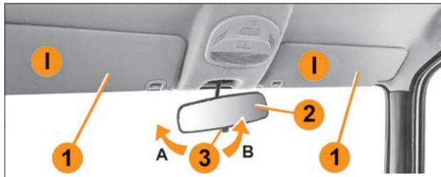
Рис. 10. Противосолнечные козырьки и зеркало заднего вида
