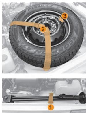
Рис. 44. Укладка и крепление домкрата и запасного колеса
