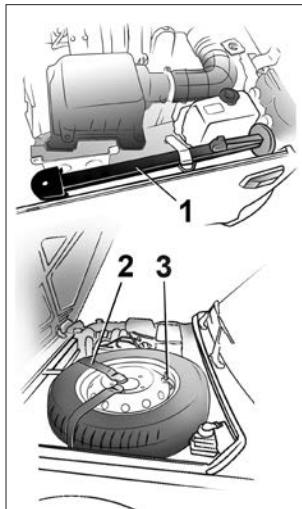
Рис. 42. Укладка и крепление домкрата и запасного колеса
