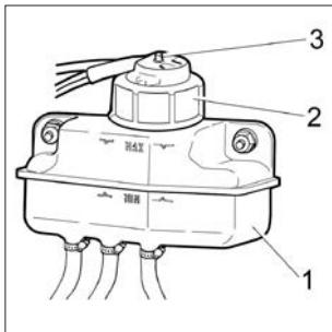
Рис. 34. Бачок гидропривода тормозов и сцепления
