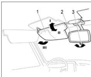
Рис. 10. Противосолнечные козырьки и зеркала
