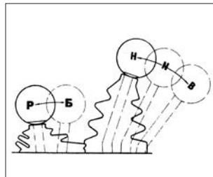
Рис. 19. Рычаги раздаточной коробки
