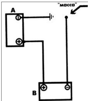
Рис. 22. Схема подключения вспомогательной батареи
