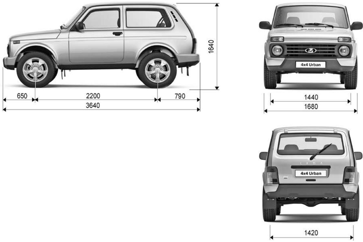
Рис.52. Габаритные размеры автомобиля LADA 4x4 Urban 3 дв.
