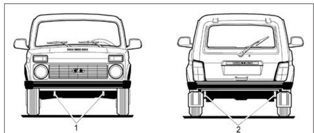
Рис. 21. Проушины для буксировки
