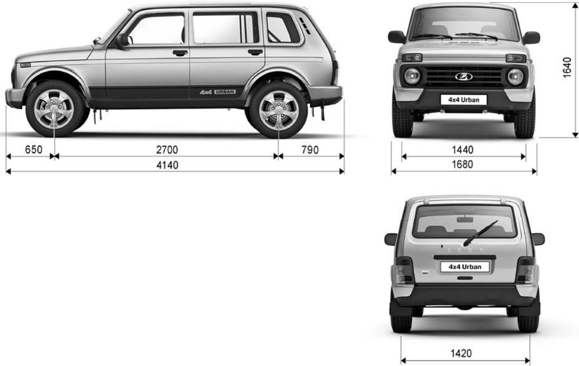
Рис. 53. Габаритные размеры автомобиля LADA 4x4 Urban 5 дв.
