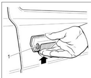
Рис. 2. Открывание дверей
