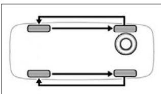
Рис. 39. Схема перестановки колес
