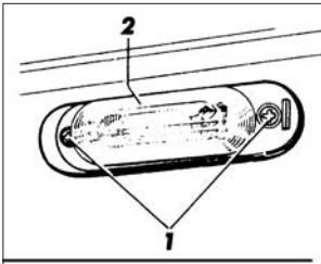
Рис. 45. Фонарь освещения номерного знака
