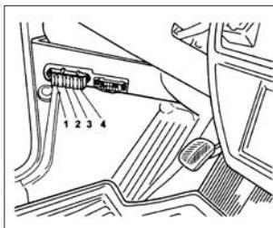
Рис. 49. Дополнительные предохранители
