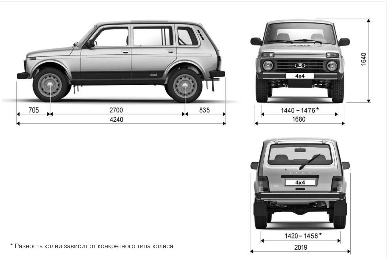
Рис. 51. Габаритные размеры автомобиля LADA 4x4 5 дв.
