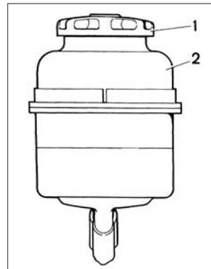
**Рис. 35. Проверка уровня жидкости в бачке гидроусилителя руля**
