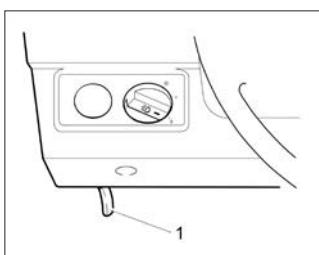
Рис. 6. Рычаг привода замка капота
