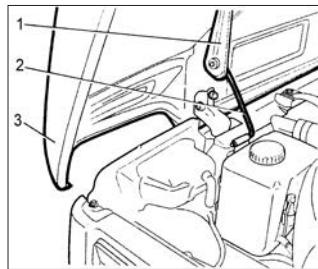
Рис. 7. Упор капота
