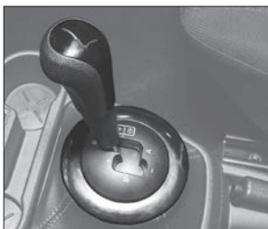
Рис. 36в. Рычаг переключения передач автоматизированной трансмиссии (АМТ)
