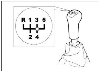
**Рис. 37. Рычаг переключения передач в механической коробке передач**
