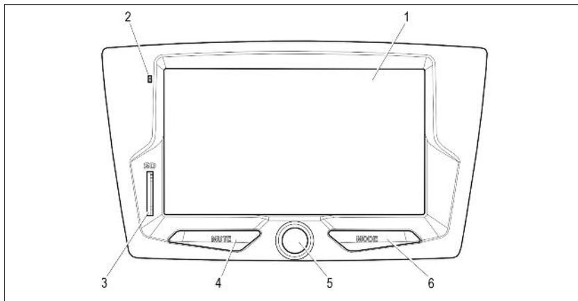
Рис. 41. Радиоприемник и проигрыватель звуковых файлов
