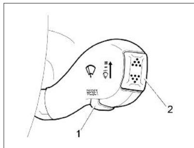
Рис. 31. Кнопки управления бортовым компьютером на рычаге переключателя стеклоочистителей (в вариантном исполнении)
