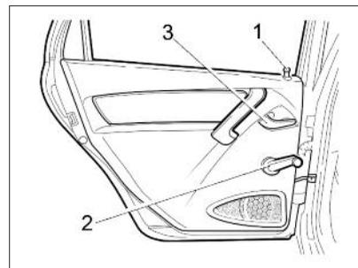
Рис. 7б. Задняя дверь с динамиком
