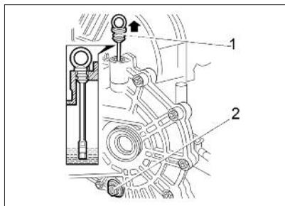
**Рис. 45б. Проверка уровня масла в коробке передач**
