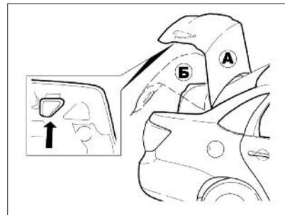
Рис. 26б. Внутренняя ручка крышки багажника
