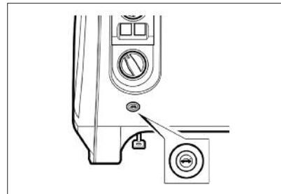
Рис. 26а. Выключатель привода замка багажника
