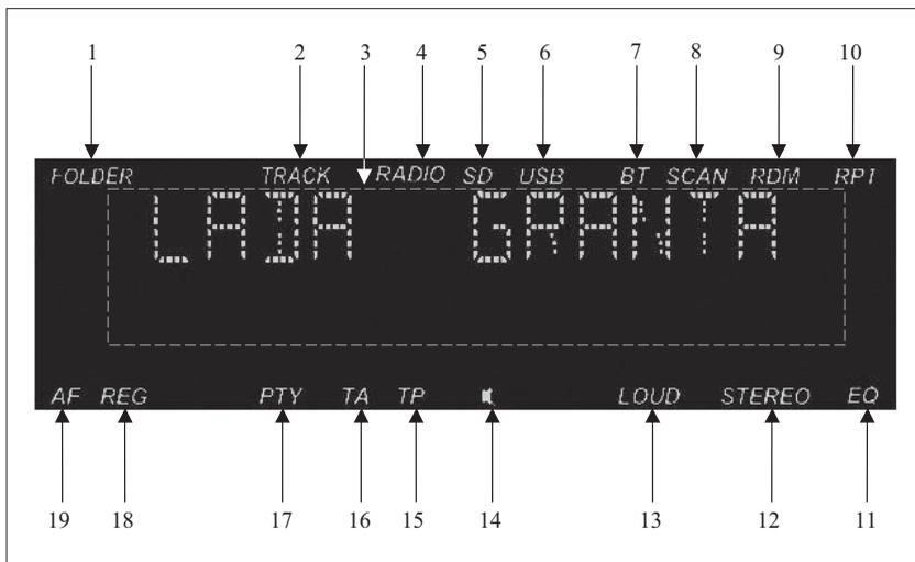
Рис. 3. Дисплей радиоприемника
