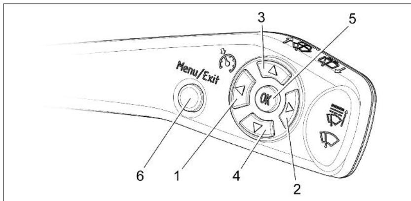
Рис. 32. Клавиши управления круиз-контролем и ограничителем скорости
