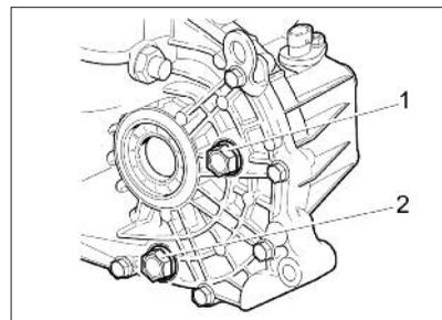
**Рис. 45в. Проверка уровня масла в коробке передач (в варианном исполнении)**
