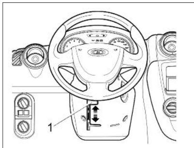
Рис. 12. Регулировка положения рулевого колеса (в варианном исполнении)
