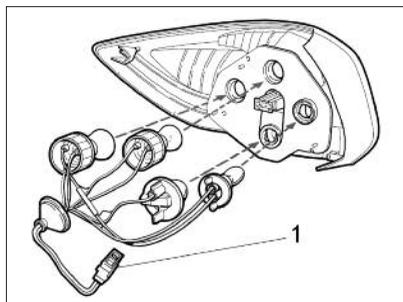
**Рис. 59б. Задний фонарь
