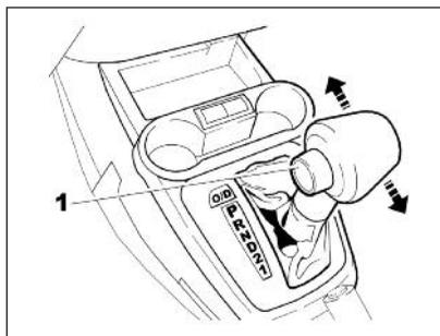
**Рис. 37б. Рычаг переключения передач в автоматической коробке передач**
