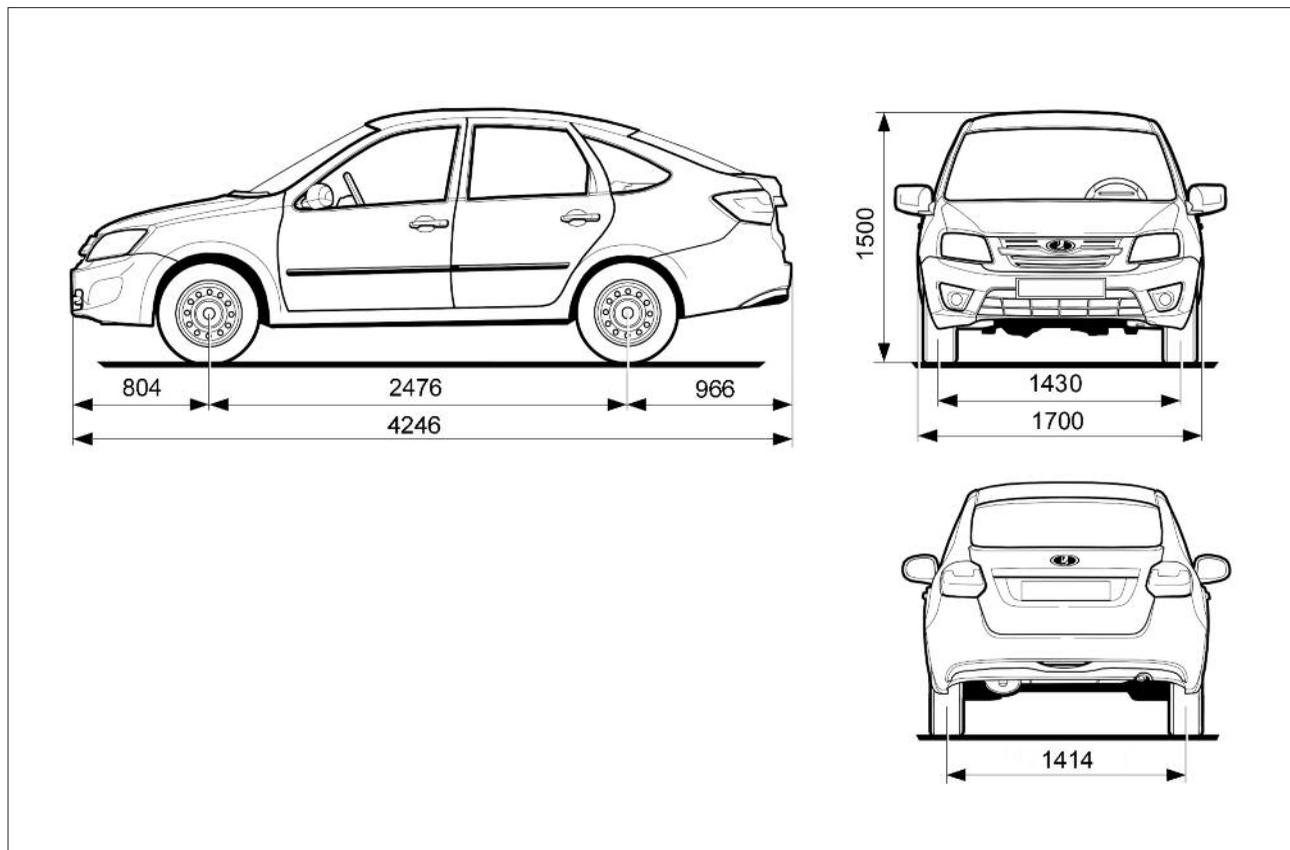
Рис. 646. Габаритные (справочные) размеры автомобиля 2191 (лифтбек)
