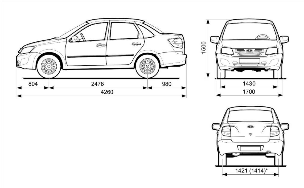
**Рис. 64а. Габаритные (справочные) размеры автомобиля 2190 (седан)**
