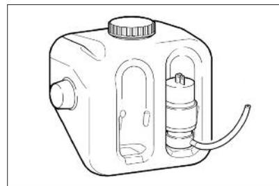
Рис. 50. Бачок стеклоомывателя
