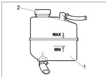
Рис. 46. Расширительный бачок
