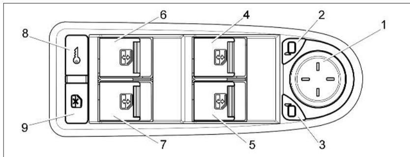
**Рис. 6б. Модуль двери водителя (в варианном исполнении)**
