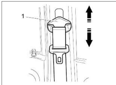
**Рис. 14б. Регулировка ремня безопасности (в варианном исполнении)**
