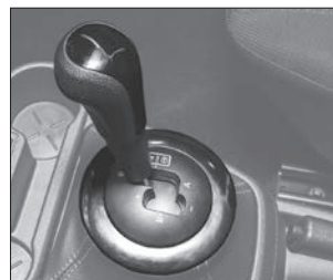
Рис. 36в. Рычаг переключения передач автоматизированной трансмиссии (АМТ)
