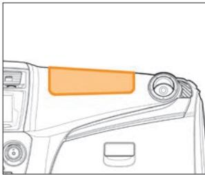
Рис. 14б. Зона размещения фронтальной подушки безопасности переднего пассажира (в вариантом исполнении)
