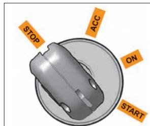
Рис. 35а. Выключатель зажигания
