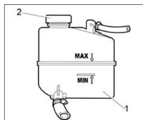
Рис. 45. Расширительный бачок
