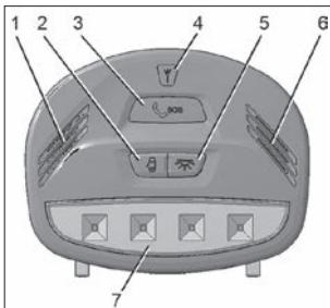
Рис. 18. Блок освещения салона 3 – клавиша экстренного вызова системы вызова экстренных оперативных служб;
