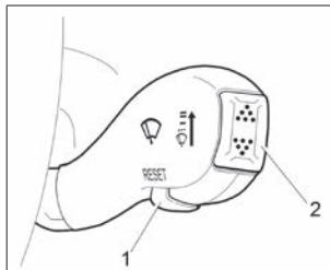
Рис. 29в. Переключатель стеклоочистителя с 2-мя клавишами управления
