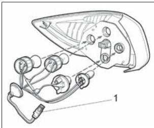
Рис. 57б. Задний фонарь автомобиля с кузовом «лифтбек»
