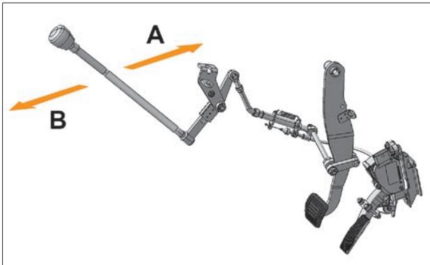
Рис. 2. Устройство ручного управления педалями акселератора и тормоза для автомобилей с автоматизированной (AMT) коробкой передач и левым расположением органов управления
