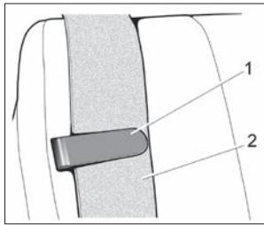
Рис. 11г. Держатель ленты ремня безопасности (в вариантом исполнении)
