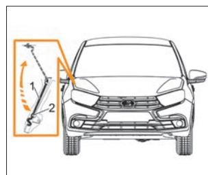
Рис. 24. Открывание капота
