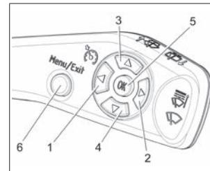
Рис. 29г. Переключатель стеклоочистителя с 6-ю клавишами управления
