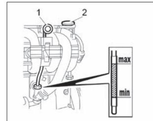
Рис. 44а. Проверка уровня масла в картере двигателя 16-клапанного двигателя
