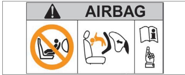
Рис. 14в. Предупреждающая табличка (в вариантом исполнении)
