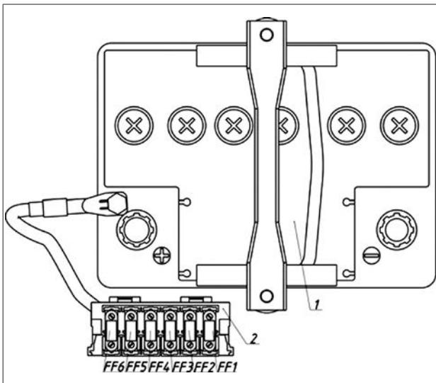
Рис. 55. Блок предохранителей
