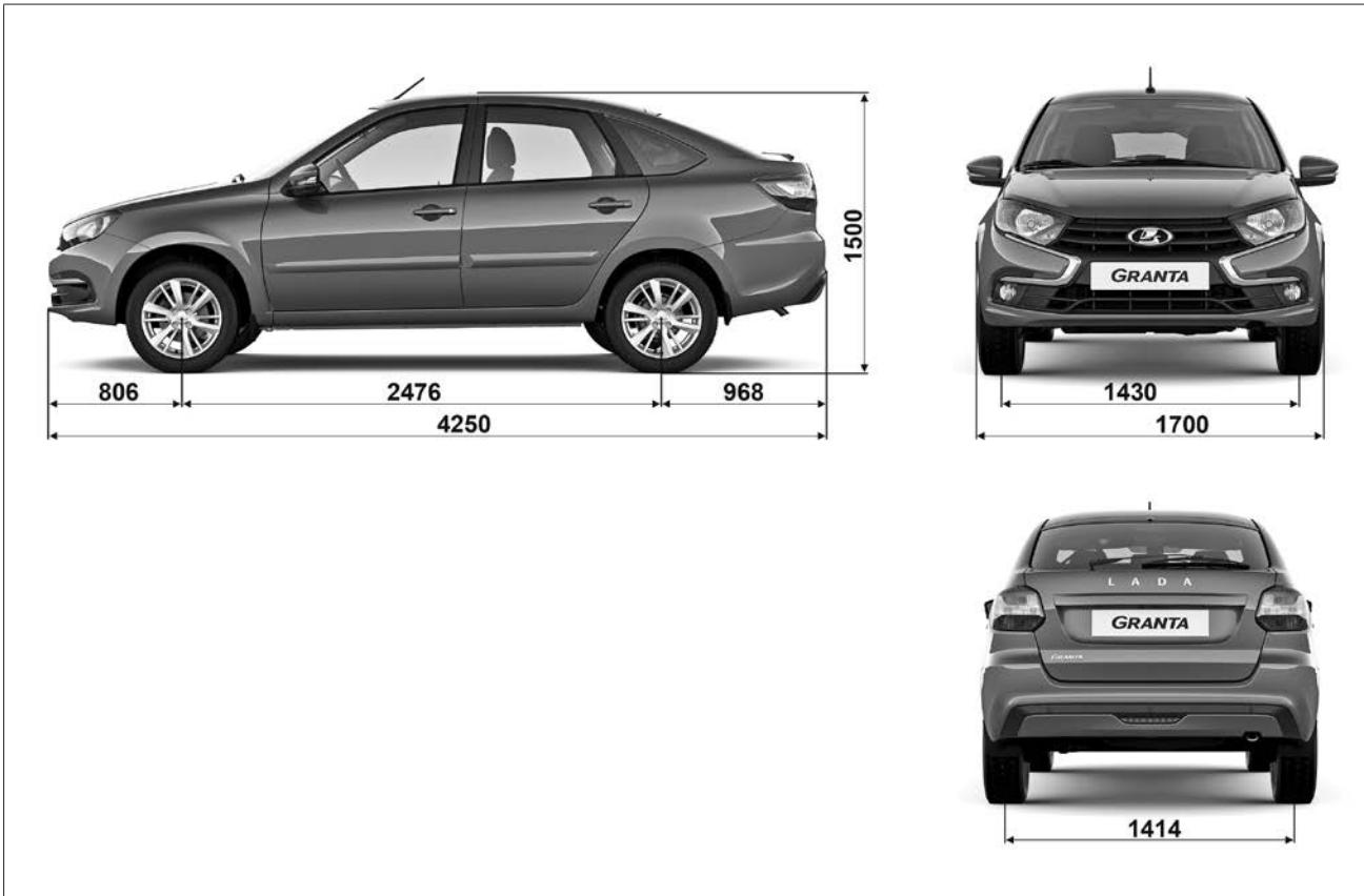
Рис. 62б. Габаритные (справочные) размеры автомобиля с кузовом «лифтбек»
