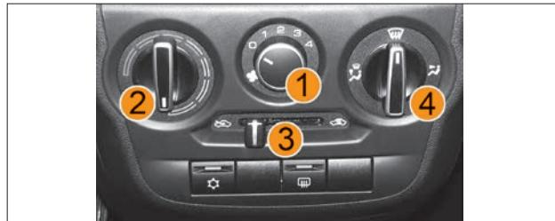
Рис. 37. Блок управления системой вентиляции и отопления
