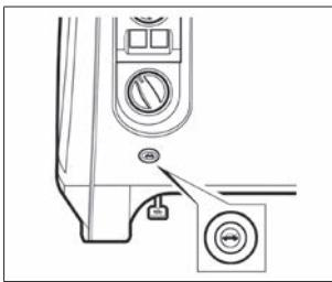
Рис. 26а. Выключатель привода замка багажника
