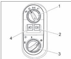
Рис. 30. Модуль управления светотехникой и корректор ближнего света фар
