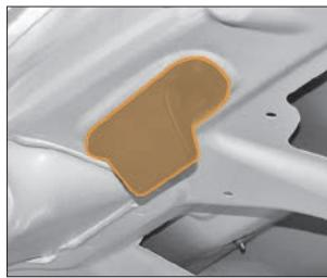
Рис. 26в. Внутренняя ручка крышки багажника
