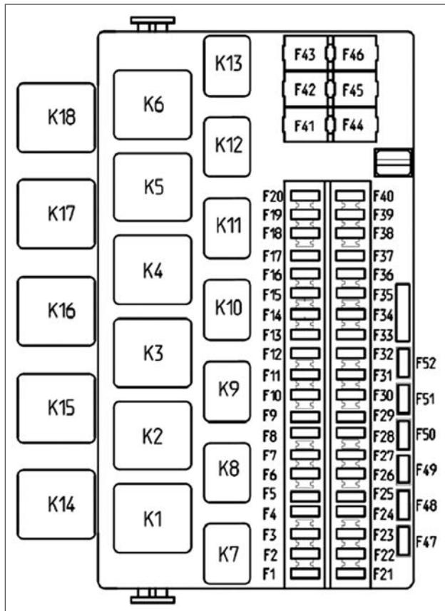
Рис. 54. Монтажный блок
