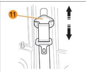
Рис. 13д. Регулировка ремня безопасности
