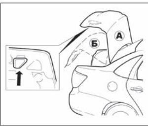
Рис. 26б. Внутренняя ручка крышки багажника
