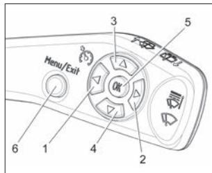
Рис. 31. Клавиши управления круиз-контролем и ограничителем скорости
