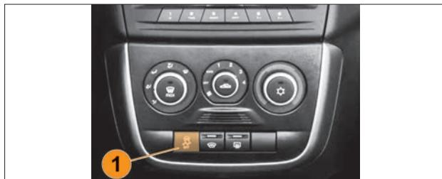
Рис. 41б. Выключатель «ESC OFF»
