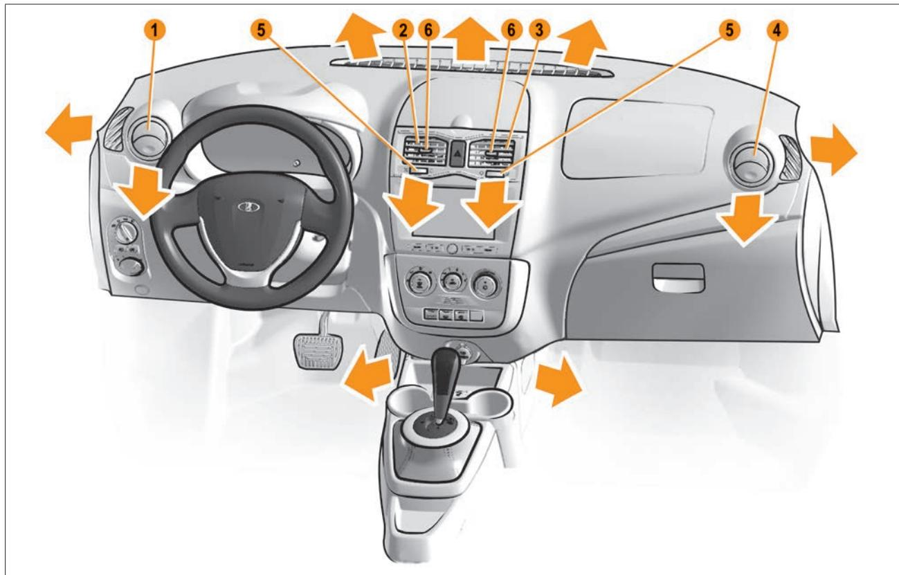
Рис. 38а. Направления потоков воздуха из дефлекторов
