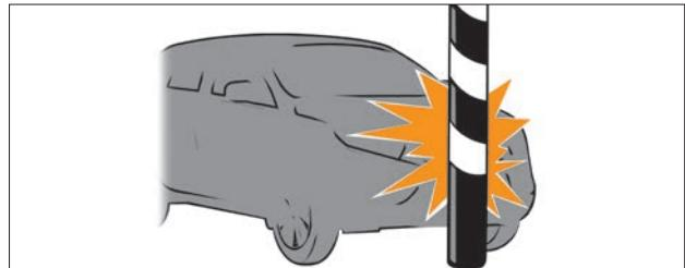
Рис. 15г. Пример ситуации с возможным несрабатыванием подушек безопасности водителя и переднего пассажира
