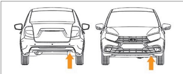
Рис. 42. Расположение буксирных проушин
