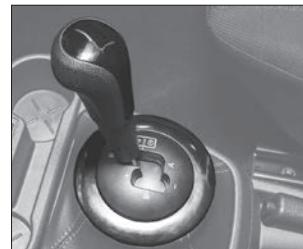
Рис. 36в. Рычаг переключения передач автоматизированной трансмиссии (AMT)
