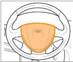
Рис. 14а. Зона размещения фронтальной подушки безопасности водителя
