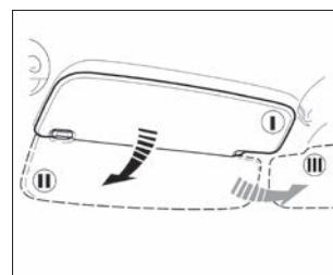
Противосолнечные козырьки в зависимости от направления лучей солнца можно установить из положения **I** (рис. 19) в положения **II** или **III**. В **вариантном исполнении** противосолнечный козырек пассажира имеет косметическое зеркало с внутренней стороны.
