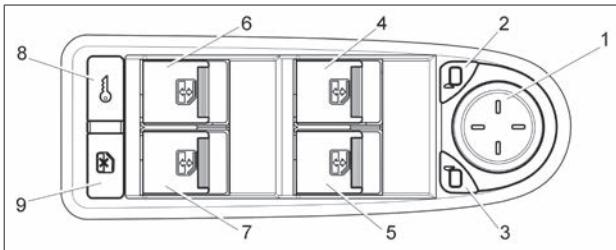
Рис. 6б. Модуль двери водителя
