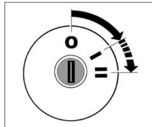
Рис. 35. Выключатель зажигания
