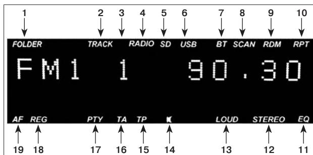
Рисунок 2. Внешний вид дисплея радиоприемника
