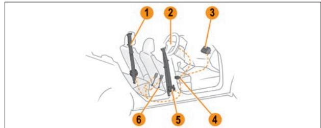
Схема устройства системы пассивной безопасности
