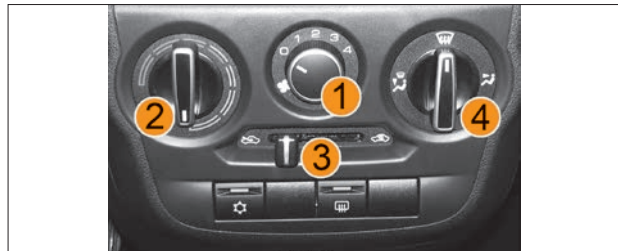
Рис. 37. Блок управления системой вентиляции и отопления
