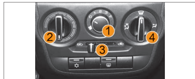
Рис. 37. Блок управления системой вентиляции и отопления
