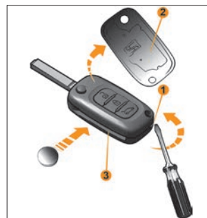
Рис. 52. Замена элемента питания пульта дистанционного управления
