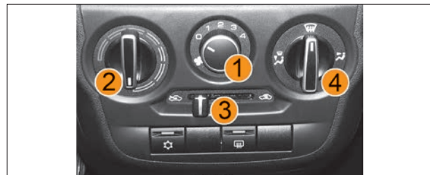
Рис. 37. Блок управления системой вентиляции и отопления
