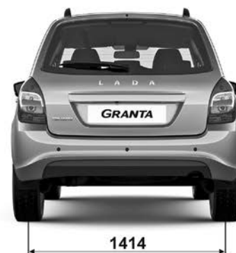
Рис. 62г. Габаритные (справочные) размеры автомобиля с кузовом «универсал»
