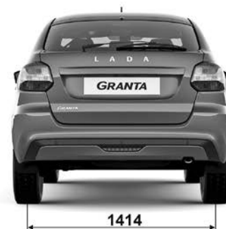
Рис. 626. Габаритные (справочные) размеры автомобиля с кузовом «лифтбек»
