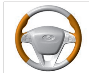
Рис. 3.4.7. Зоны максимального обогрева рулевого колеса
