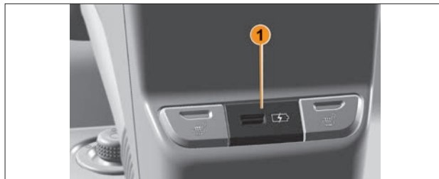
Рис. 4.4.4. USB-розетка 5 В (в варианном исполнении)
