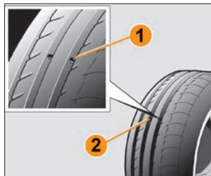
Рис. 6.9.4. Выступы-индикаторы на шинах
