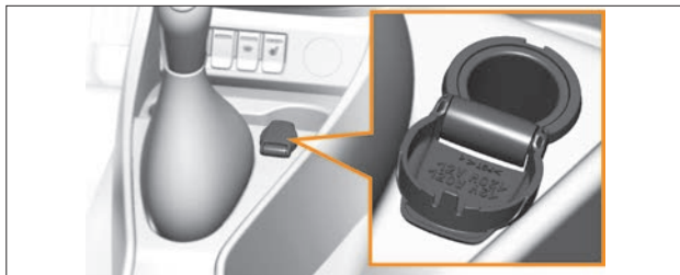
Рис. 4.4.1. Розетка 12 В для водителя и переднего пассажира
