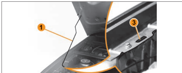
Рис. 6.2.4. Установка упора капота
