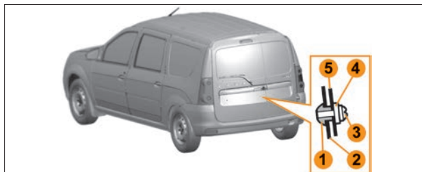
Рис. 5.1.2. Установка заднего номерного знака
