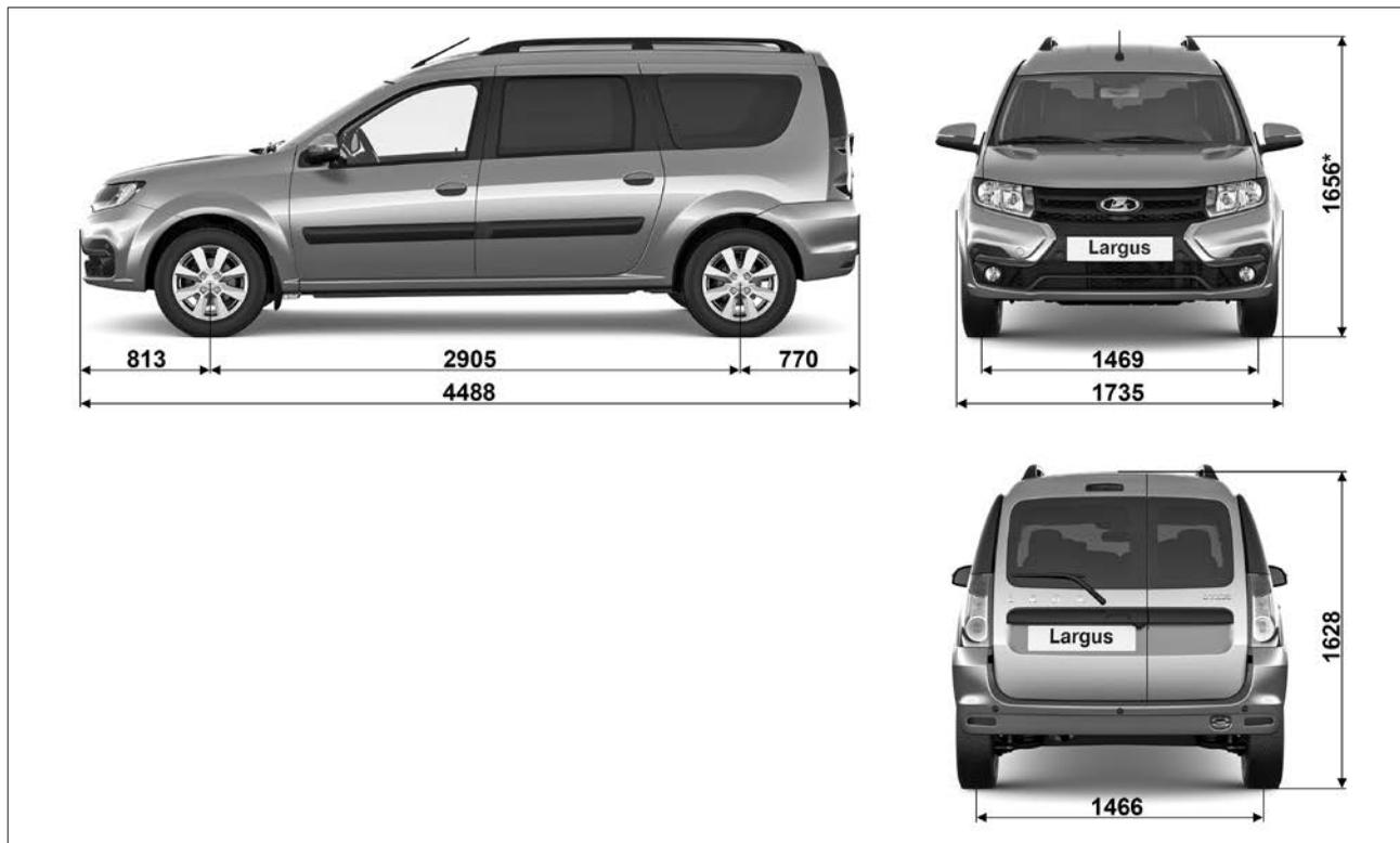
Рис. 7.2.1. Габаритные (справочные) размеры автомобиля L Largus «универсал»
