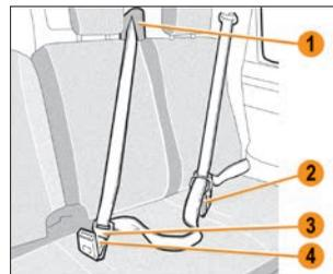
Рис. 2.5.6. Пристёгивание средним ремнём безопасности (в варианном исполнении)
