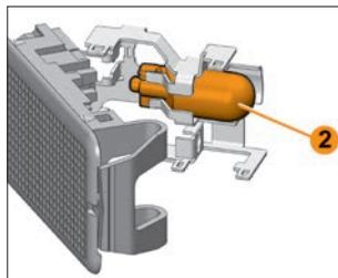
Рис. 6.13.12. Лампа освещения вещевого ящика (в варианном исполнении)
