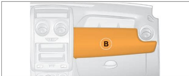
**Рис. 2.6.2. Размещение подушки безопасности переднего пассажира (в варианном исполнении)**
