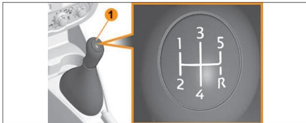
Рис. 3.7.1. Рычаг переключения передач
