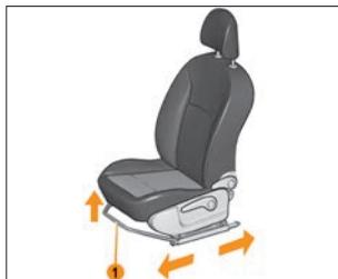
Рис. 2.1.1. Регулировка переднего сиденья
