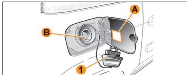
**Рис. 5.17.1. Пробка наливной трубы топливного бака (в варианном исполнении)**
