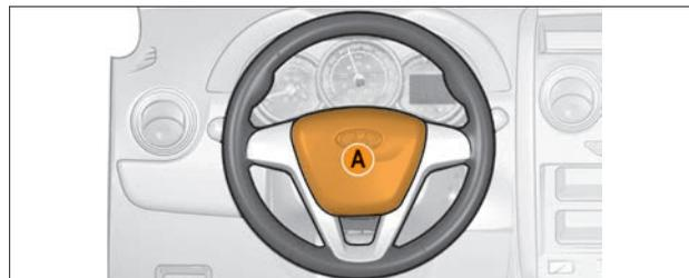
Рис. 2.6.1. Размещение подушки безопасности водителя
