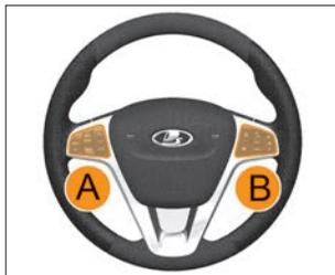
Рис. 3.4.3. Дополнительные блоки управления (в варианном исполнении)
