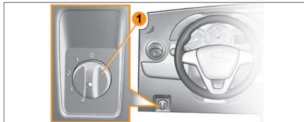
Рис. 3.10.1. Переключатель корректора угла наклона света фар
