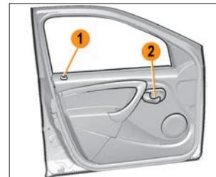
Рис. 1.4.2. Открытие передних дверей изнутри (в варианном исполнении)
