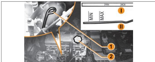
Рис. 6.3.1. Масляный щуп двигателя
