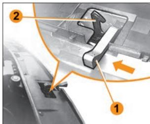
Рис. 6.2.2. Предохранительный крюк замка капота (в варианном исполнении)
