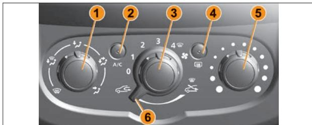
Рис. 3.12.3. Блок управления климатической системой (в варианном исполнении)
