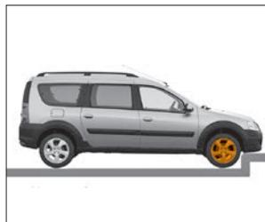
Рис. 2.6.6. Пример срабатывания фронтальных подушек безопасности при ударе о бордюр, кромку тротуара или твердый материал
