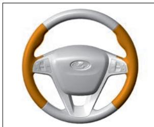
Рис. 3.4.7. Зоны максимального обогрева рулевого колеса
