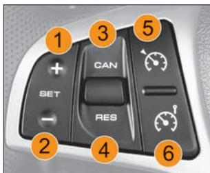
Рис. 5.11.1. Клавиши управления системами «Круиз-контроль» и «Ограничитель скорости» (в варианном исполнении)
