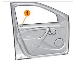
Рис. 1.3.2. Блокировка/разблокировка замков дверей изнутри (в варианном исполнении)
