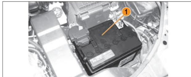
Рис. 6.10.1. Аккумуляторная батарея (в варианном исполнении)
