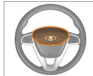
Рис. 3.4.2. Выключатель звукового сигнала
