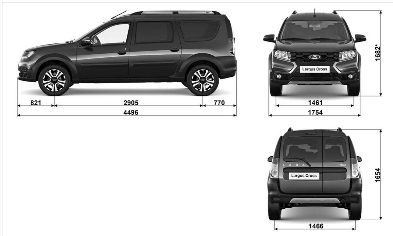
Рис. 7.2.3. Габаритные (справочные) размеры автомобиля Largus Cross
