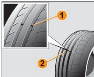
Рис. 6.9.4. Выступы-индикаторы на шинах (в варианном исполнении)
