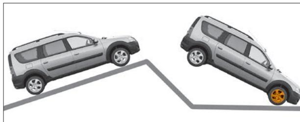
Рис. 2.6.8. Пример срабатывания фронтальных подушек безопасности при жёстком приземлении или падении с выступа
