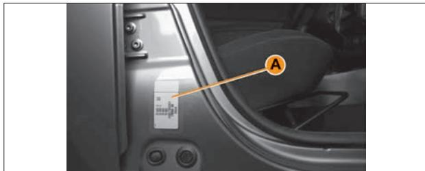
Рис. 7.1.1. Место размещения таблички изготовителя (в варианном исполнении)
