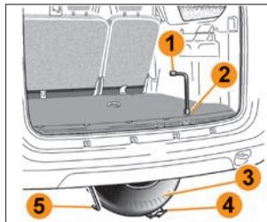
Рис. 6.9.1. Снятие запасного колеса (в варианном исполнении)
