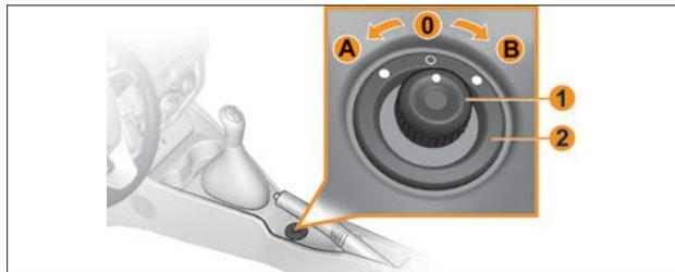
Рис. 3.11.3. Рукоятка управления электроприводом зеркал
