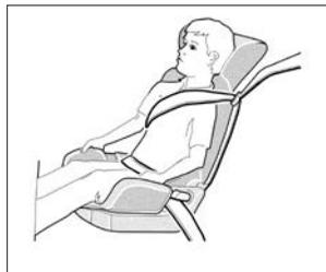
**Рис. 2.8.1. Пример специальной подушки-бустера**
