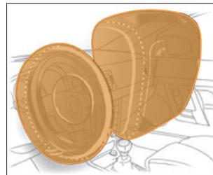
**Рис. 2.6.4. Пример срабатывания подушек безопасности водителя и переднего пассажира (в варианном исполнении)**
