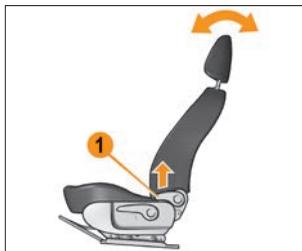
Рис. 2.1.2. Регулировка спинки переднего сиденья
