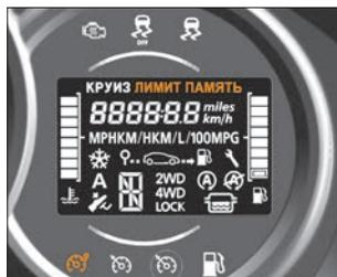
Рис. 5.11.2. Индикация системы «Ограничитель скорости» (в варианном исполнении)
