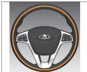
Рис. 3.4.6. Зоны обогрева рулевого колеса (в варианном исполнении)
