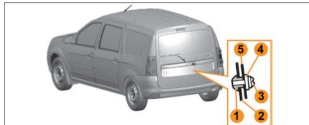
Рис. 5.1.2. Установка заднего номерного знака
