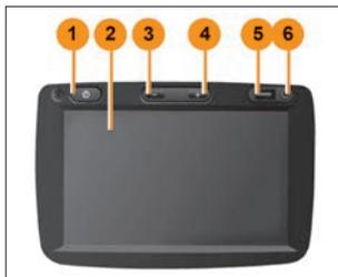
Рис. 4.6.3. Внешний вид мультимедийной системы (в варианном исполнении)
