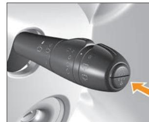
Рис. 3.3.2. Кнопки управления бортовым компьютером
