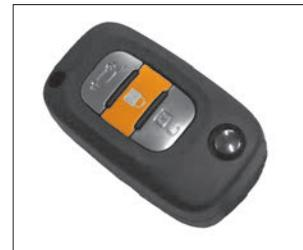
Рис. 1.2.2. Кнопка «БЛОКИРОВКА» ПДУ
