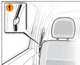
Рис. 2.2.7. Крючок для фиксации ремня безопасности (в варианном исполнении)
