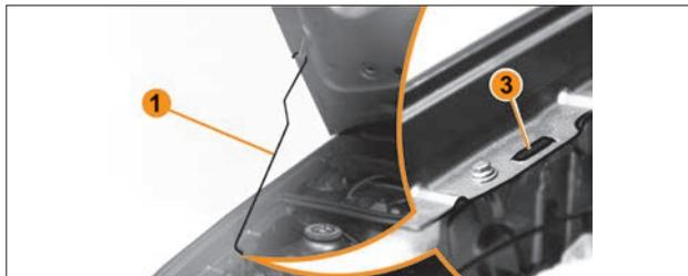
Рис. 6.2.4. Установка упора капота
