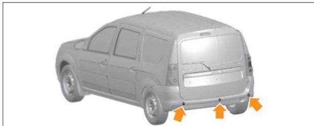
**Рис. 5.13.1. Задние датчики СБП
