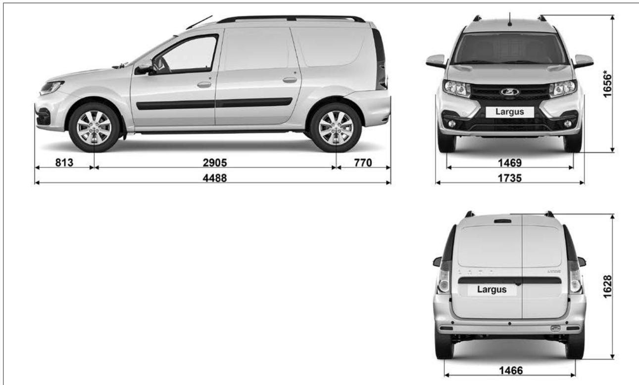
Рис. 7.2.2. Габаритные (справочные) размеры автомобиля Largus «фургон»
