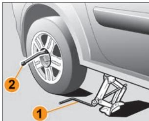
**Рис. 6.9.3. Снятие колеса
