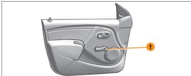
Рис. 4.1.1. Рукоятка привода стеклоподъемника
