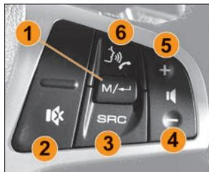
Рис. 4.6.4. Дополнительный блок управления мультимедийной системой (в варианном исполнении)
