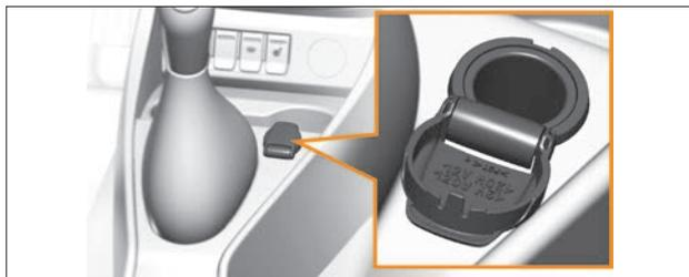
Рис. 4.4.1. Розетка 12 В для водителя и переднего пассажира (в варианном исполнении)
