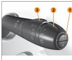
Рис. 3.9.7. Кольца и кнопки управления на правом рычаге подрулевого переключателя (в варианном исполнении)
