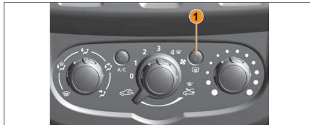
**Рис. 3.11.4. Выключатель обогрева наружных зеркал (в варианном исполнении)**
