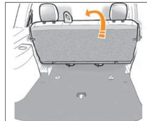
Рис. 2.2.5. Складывание сиденья второго ряда (**в варианном исполнении**)
