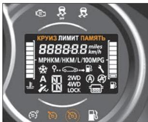
Рис. 5.11.3. Индикация системы «Круиз-контроль» (в варианном исполнении)
