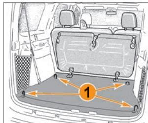
Рис. 5.7.1. Крепления в багажном отделении (в *вариантном исполнении*)
