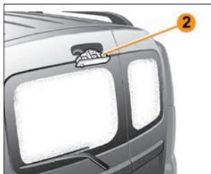
Рис. 6.13.7. Фонарь дополнительного сигнала торможения
