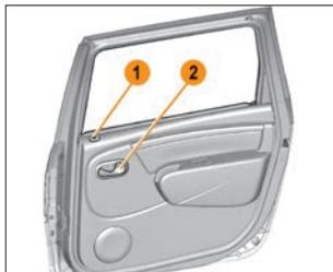
Рис. 1.4.3. Открытие задних дверей изнутри
