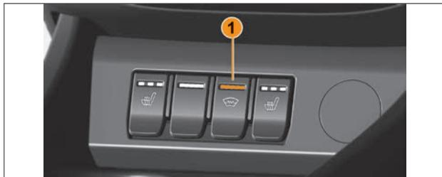
**Рис. 3.12.4. Выключатель обогрева ветрового стекла (в варианном исполнении)**
