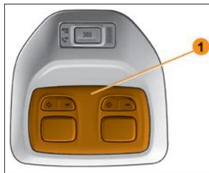
Рис. 6.13.9. Блок освещения салона
