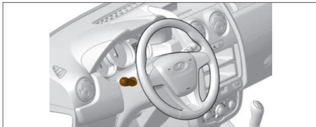
Рис. 3.9.1. Левый рычаг подрулевого переключателя
