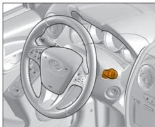
Рис. 3.9.6. Правый рычаг подрулевого переключателя (в варианном исполнении)
