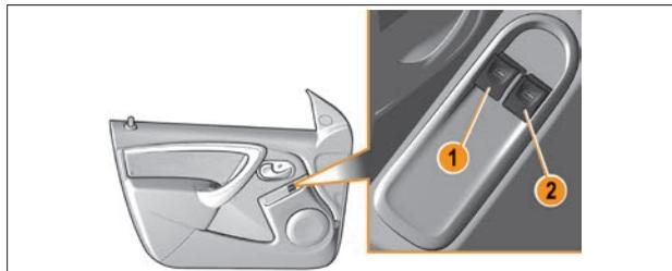
Рис. 4.1.2. Блок управления электростеклоподъемниками А
