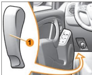
Рис. 6.2.1. Рукоятка разблокировки замка капота (в варианном исполнении)
