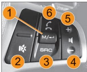
**Рис. 4.6.2. Дополнительный блок управления аудиосистемой (в варианном исполнении)**
