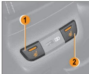
Рис. 2.2.4. Выключатели обогрева сиденья второго ряда (**в варианном исполнении**)
