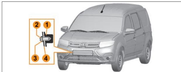
Рис. 5.1.1. Установка переднего номерного знака
