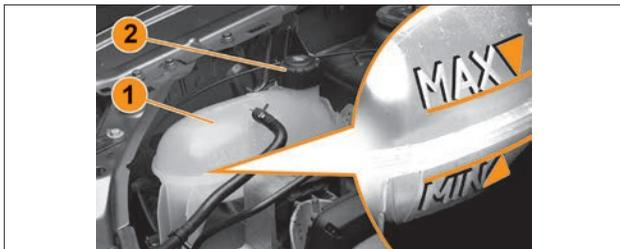
Рис. 6.4.1. Бачок системы охлаждения двигателя
