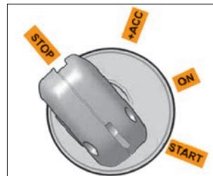
Рис. 3.5.1. Выключатель зажигания
