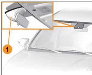
Рис. 3.9.5. Датчик освещенности и датчик дождя (в варианном исполнении)
