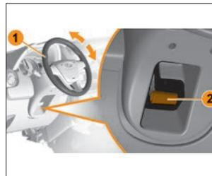
Рис. 3.4.1. Регулировка положения рулевого колеса
