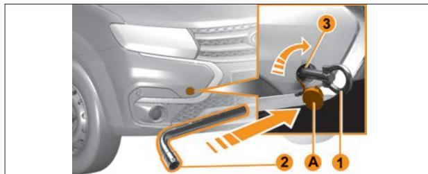
Рис. 6.14.1. Передняя вворачиваемая буксирная проушина (в варианном исполнении)
