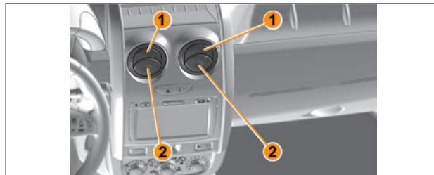
**Рис. 3.12.2. Регулируемые дефлекторы климатической системы (в варианном исполнении)**
