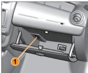
Рис. 6.13.11. Плафон освещения вещевого ящика (в варианном исполнении)
