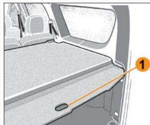
Рис. 5.7.3. Натяжная полка багажного отделения (в *вариантном исполнении*)
