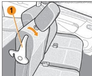
Рис. 2.2.8. Ручка фиксатора сиденья второго ряда (в варианном исполнении)
