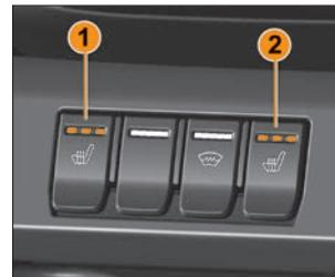
Рис. 2.1.6. Клавиши управления подогревом передних сидений (в варианном исполнении)
