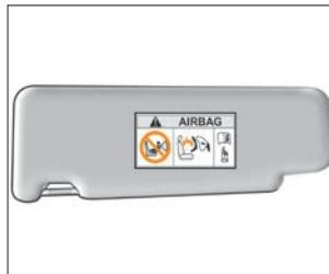
**Рис. 2.6.3. Наклейка с предупреждением (в варианном исполнении)**
