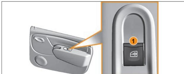
Рис. 4.1.5. Клавиша управления электростеклоподъемником с места заднего пассажира (в варианном исполнении)
