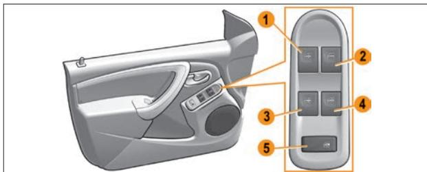
Рис. 4.1.3. Блок управления электростеклоподъемниками В (в варианном исполнении)
