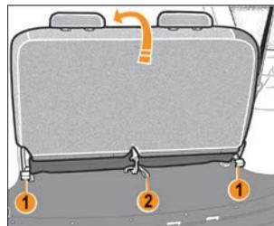
Рис. 2.3.2. Складывание сиденья третьего ряда (в варианном исполнении)
