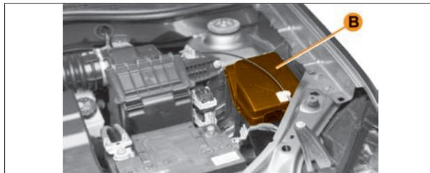
Рис. 6.12.2. Крышка монтажного блока
