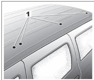
В зависимости от комплектации автомобиля, вывинтите резьбовые заглушки **1**, защищающие места для установки винтов крепления багажника.
