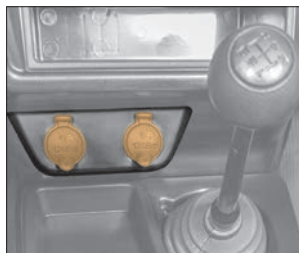
Рис. 17. Розетки для подключения дополнительного электрооборудования в салоне
