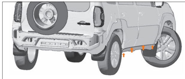
Рис. 89. Дренажные отверстия дверей и порогов
