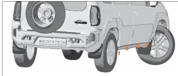
Рис. 89. Дренажные отверстия дверей и порогов
