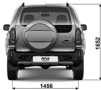
Рис. 90. Габаритные (справочные) размеры автомобиля (в варианном исполнении)
