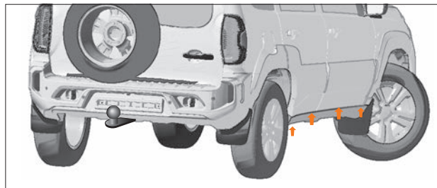
Рис. 89. Дренажные отверстия дверей и порогов
