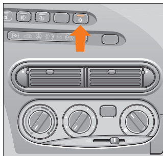
Рис. 63. Предохранение стёкол от запотевания и замерзания
