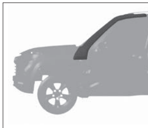
Рис. 35. Шноркель (в варианте исполнения)
