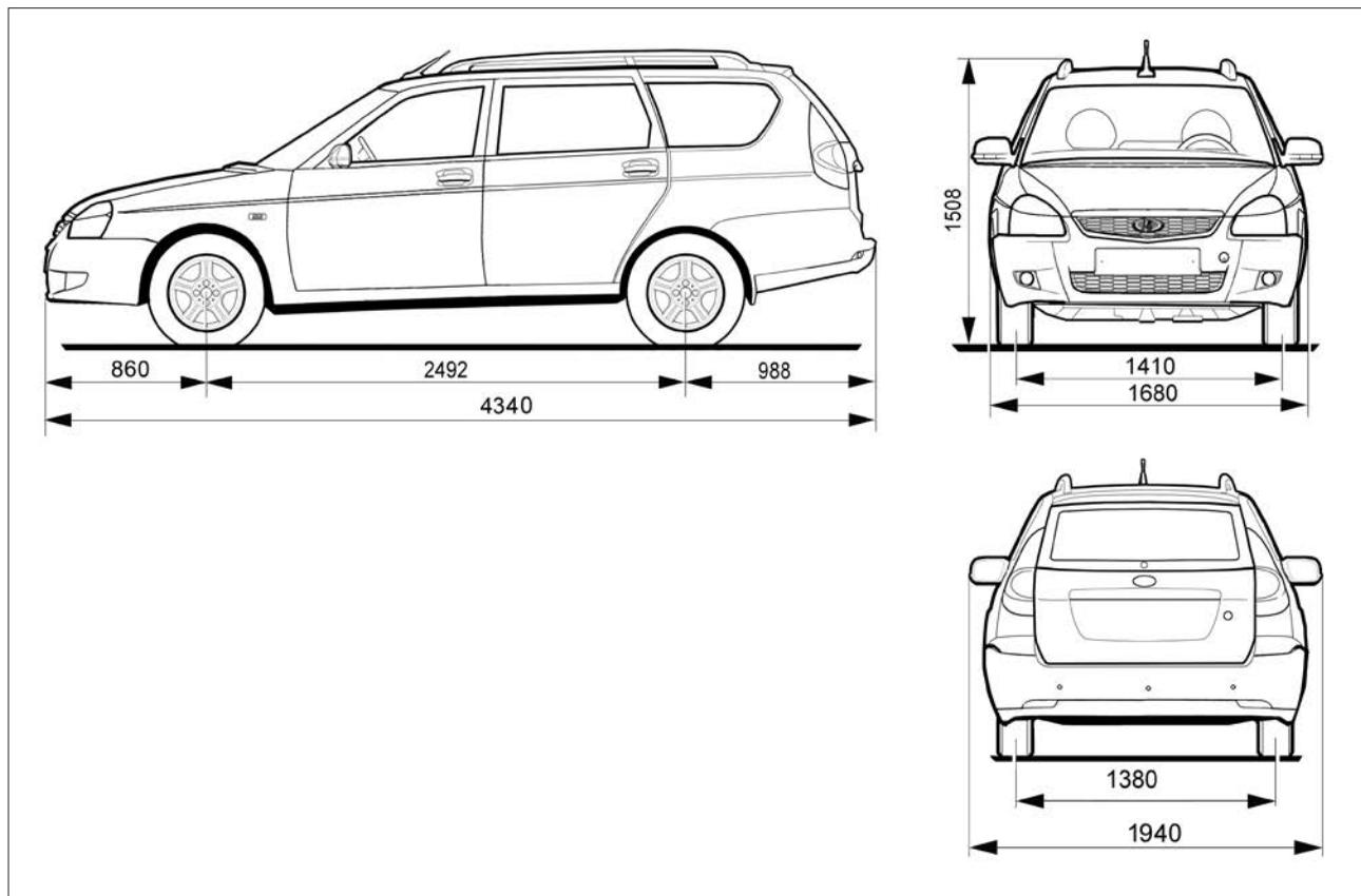
Рис. 95. Габаритные (справочные) размеры автомобиля ВАЗ-2171 (универсал)
