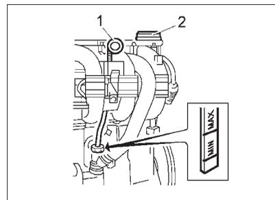
Рис. 74. Проверка уровня масла в картере двигателя
