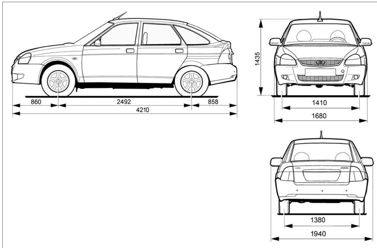
Рис. 94. Габаритные (справочные) размеры автомобиля ВАЗ-2172 (хэтчбек)
