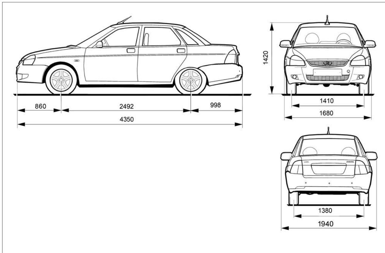
Рис. 93. Габаритные (справочные) размеры автомобиля ВАЗ-2170 (седан)
