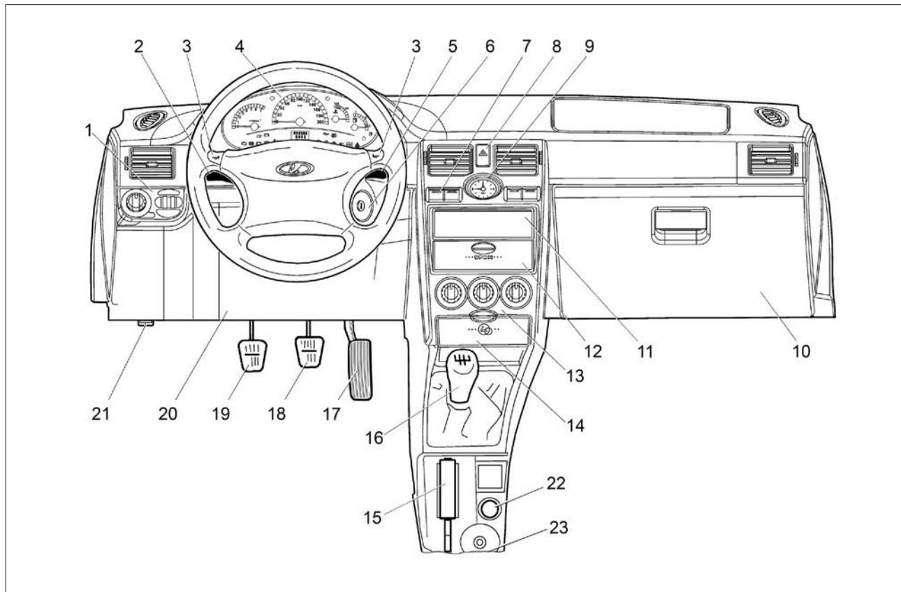
Рис. 38. Органы управления и приборы
