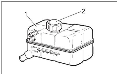
Рис. 78. Расширительный бачок
