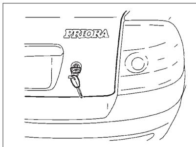
Рис. 36. Открывание багажника
