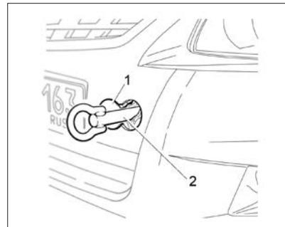
Рис. 72. Буксировочное устройство
