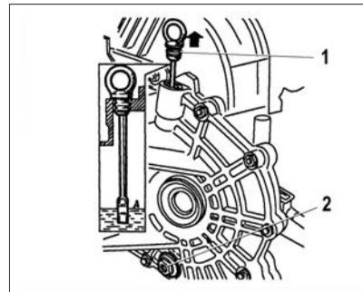
Рис. 75. Проверка уровня масла в коробке передач
