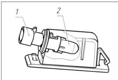
**Рис. 90а. Фонарь освещения номерного знака (для модели 2171)**
