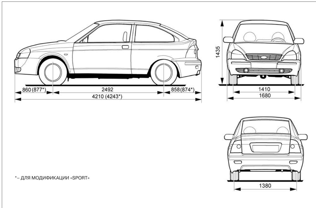
Рис. 96. Габаритные и справочные размеры автомобиля LADA 2172 Coupe
