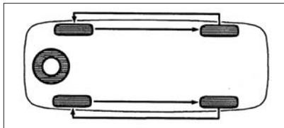
Рис. 82. Перестановка колес
