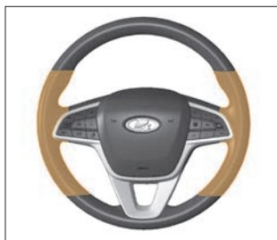
Рис. 3.4.9. Зоны максимального обогрева рулевого колеса
