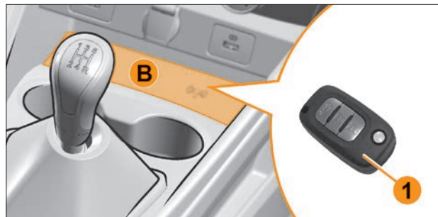
Рис. 3.5.3. Место размещения считывающего устройства
