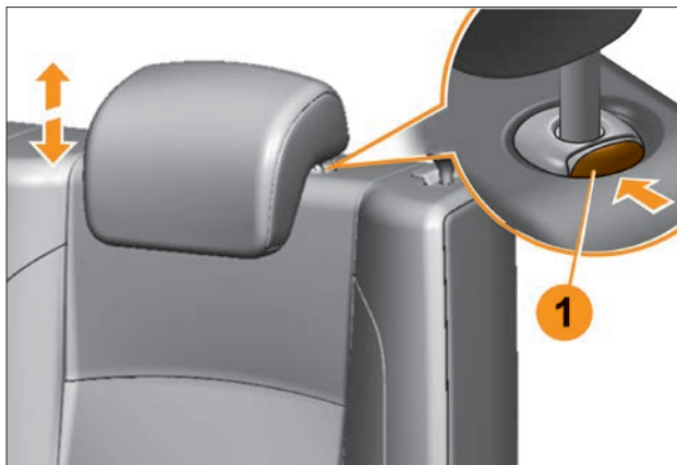
Рис. 2.2.1. Регулировка подголовников сиденья второго ряда
