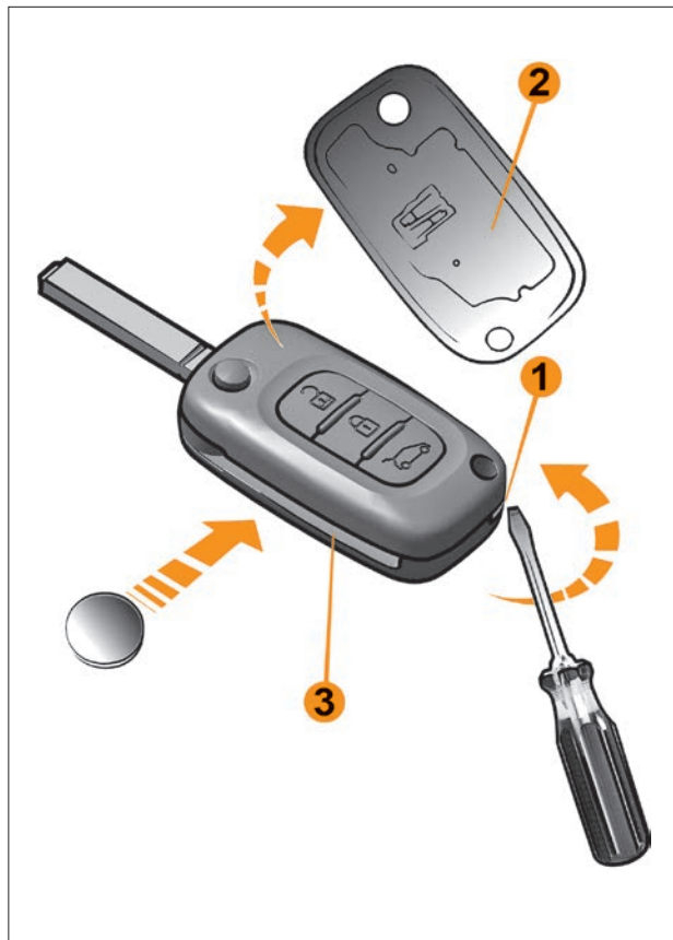
Рис. 6.10.1. Замена элемента питания в ПДУ
