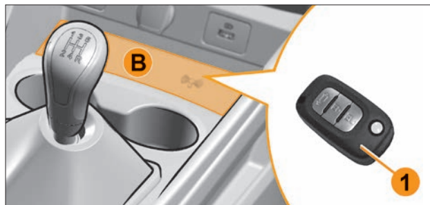
Рис. 5.10.2. Место размещения считывающего устройства
