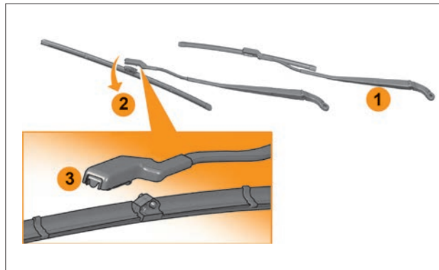
Рис. 6.7.2. Замена щеток стеклоочистителя ветрового стекла
